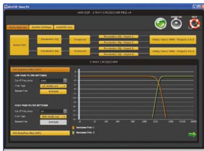
Figure 5. Dans le filtre répartiteur : la fréquence de coupure, le type de filtre et la pente sont ajustables. Possibilité de rajouter un passe-haut pour obtenir un passe-bande.
