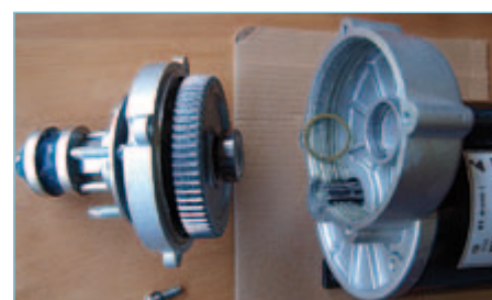
Figure 8. Après avoir retiré les quatre vis du couvercle du motoréducteur, écartez le couvercle avec l'arbre et la roue dentée du moteur.
