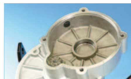
Figure 9. Position correcte du trou de montage du capteur de roue dentée sur l'Elektor-Wheelie.
