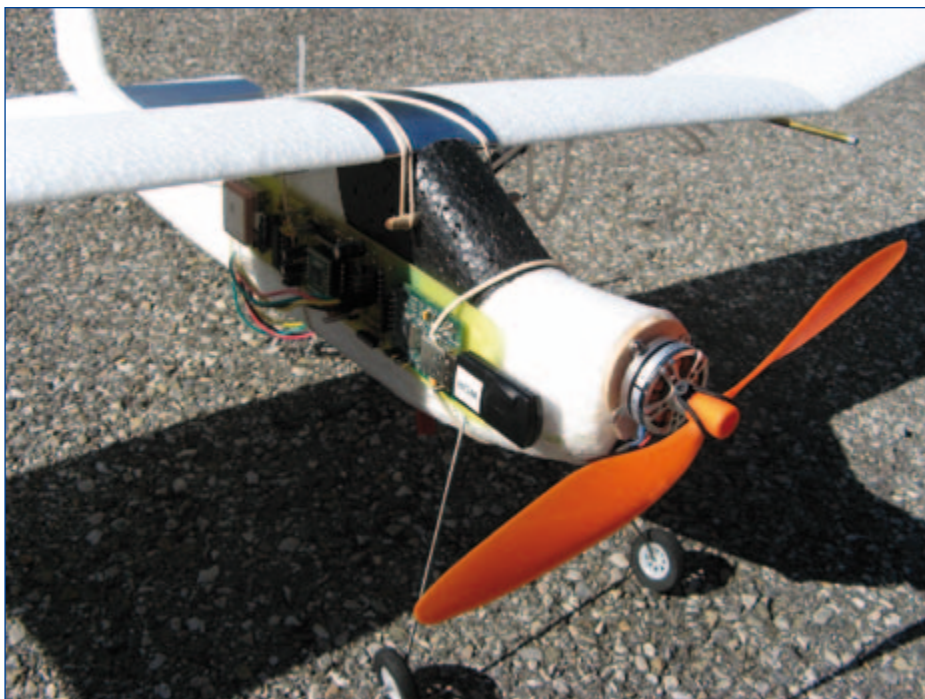
Figure 4. L'enregistreur de vol a été fait sur mesure pour le Wizz [4].
