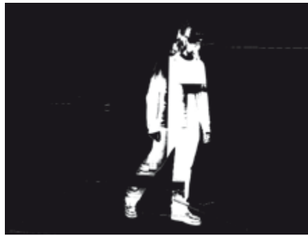
Figure 4. Résultat d'une étape supplémentaire : Un pixel blanc apparaît ici si la différence des valeurs de gris excède un seuil déterminé.
