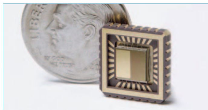
Figure 11. La puce SensorChip-CO 2 est une puce MEMS pour mesurer le CO 2 (photo : ICX Technologies).
