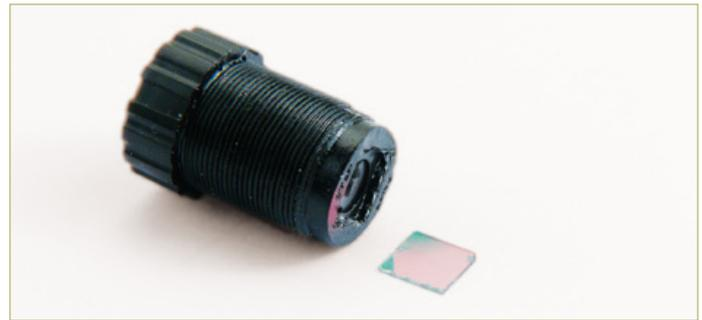
Figure 3. Il est assez facile de retirer le filtre IR de l'objectif d'une caméra Konig.
