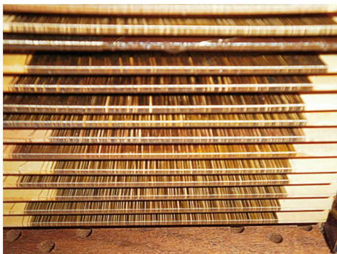
Les résistances des calibres sont bobinées à plat pour avoir une auto-inductance négligeable donc une bande passante étendue et sont ajustées à l'ohm près. Il y en a 14 (pour six calibres), ce qui permet de réduire la puissance dissipée dans chacune (jamais plus de 1,5 W) donc la dérive thermique, d'autant qu'elles sont particulièrement bien ventilées : précision, précision, précision !
