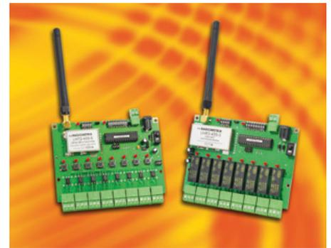
L'ensemble se compose de deux circuits intégrés CTA88-000-DIL, d'une platine codeur CTA88 (avec huit entrées photocouplées), d'une platine décodeur CTA88 (avec huit sorties relais) ainsi que d'antennes quart d'onde ou hélicoïdales. Les platines disposent de quatre cavaliers pour la sélection des modes de fonctionnement ainsi que d'interrupteurs DIP pour la configuration des adresses et des fréquences.
