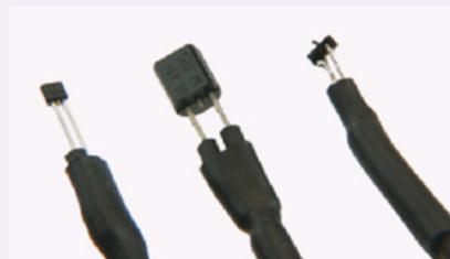
La résistance des capteurs doit être aussi élevée que possible. Cela permet d'avoir un diviseur de tension dimensionné avec une haute impédance, et aux capteurs d'avoir un échauffement propre plus faible. Les types listés font tous environ 2 kΩ à 25 °C et sont en outre moins chers que les capteurs PT2000 de la platine. La stabilité à long terme de ces composants, dont dépend celle du présent circuit, est comparable.
