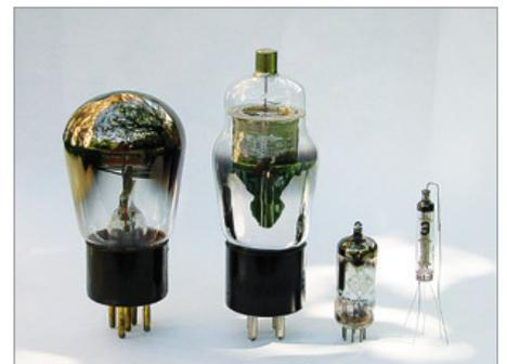
de fonctionnement employé basé sur l'optique électronique, c'est-à-dire que le tube ne comporte que des tiges de métal et pas de bobinages (les différentes grilles à l'intérieur). Ceci explique la très petite taille de ces tubes. Je pense qu'un article sur ce mode de fonctionnement serait très intéressant, car ce mode de fonctionnement est peu connu.
