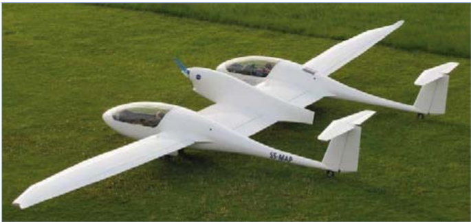
Figure 7. Ce Pipistrel venu de Slovénie pour le GFC a combiné deux planeurs à moteur Taurus dans un avion à double fuselage, avec un moteur électrique de 145 kW. Cela a un sens, car la compétition évalue la consommation par siège. (Source : Pipistrel)
