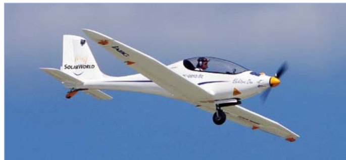
Figure 4. L'Electra One de la société allemande de développement PC-Aero participe au Green Flight Challenge (GFC). Il sera proposé ci-inclus un hangar à toit solaire de Solarworld pour recharger les accumulateurs. (Source : PC-Aero, Copyright Shahn Sederberg)
