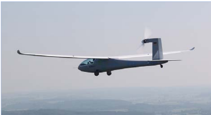
Figure 8. Initialement dénommé « Hydrogenius », le e-Genius de l’université de Stuttgart conçu avec une pile à combustible est désormais un avion électrique électrique très performant prenant part au GFC. (Source : e-Genius-Team, IFB Universität Stuttgart)
