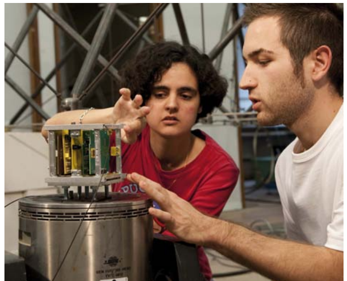
Figure 9. Essai de test en vibration du cubesat sur pot vibrant. (source : CNES)
