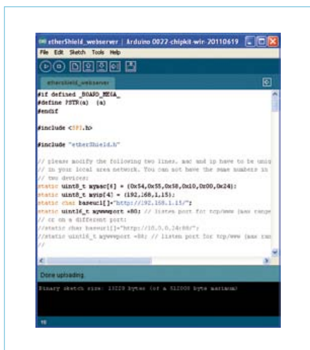
Figure 1. L'EDI Max32 montrant un #define pour enlever le code spécifique AVR.
