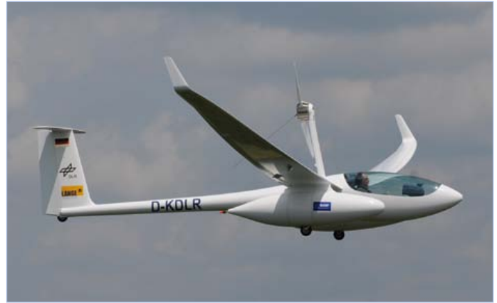
Figure 2. Antares 20E de Lange Aviation – ici dans la version DLR avec pile à combustible et le réservoir d'hydrogène dans les réservoirs d'aile. Il s'agit du premier avion électrique approuvé par l'EASA avec le seul moteur électrique déjà approuvé comme moteur d'avion. (Source : DLR)
