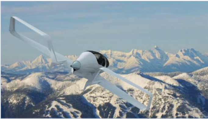
Figure 5. Le Synergy de six places participera au GFC avec un moteur biodiesel de 142 kW (193 ch). (Source : CAFE Foundation Blog)
