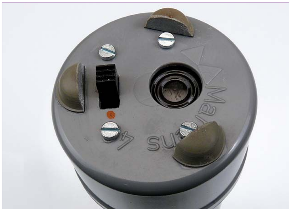
Figure 4. Nous avons installé l'interrupteur marche/arrêt et le haut-parleur dans le bouchon.
