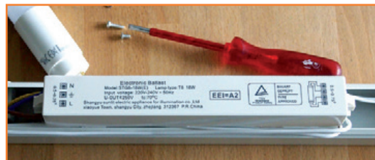
Figure 4. La lampe ouverte montre le ballast électronique.
