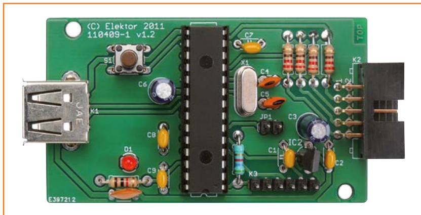
Figure 3. Le prototype de l'enregistreur de données sérielles de janvier 2012. Le microcontrôleur enregistre sur une simple clé USB les données en provenance de l'interface sérielle.
