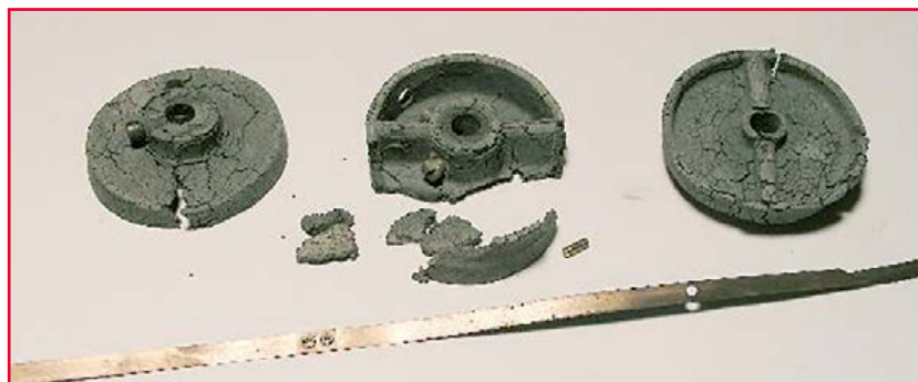
Figure 3. Poulies désagrégées. Photo reproduite avec l'autorisation d'Allen Wooten, WD4EUI.
