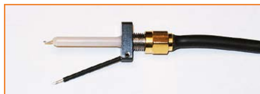
Figure 6. Une ancienne sonde à basse impédance de HP.
