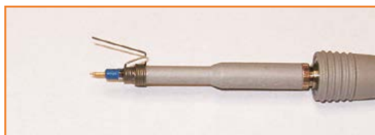
Figure 2. Sur cette sonde de mesure de la firme Agilent , le fil de masse a été remplacé par un ressort.
