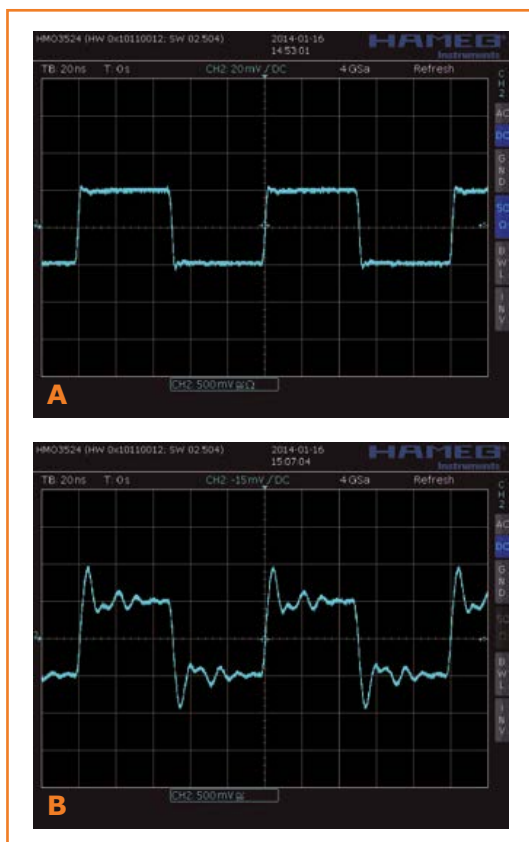
Figure 1. Un signal rectangulaire à 10 MHz avec câble et terminaison de 50\ \Omega dans l'oscilloscope (A) : le même mesuré avec une sonde et fil de masse sur la terminaison (B).
