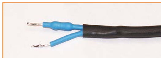
Figure 5. La sonde de mesure à basse impédance que j'ai fabriquée.
