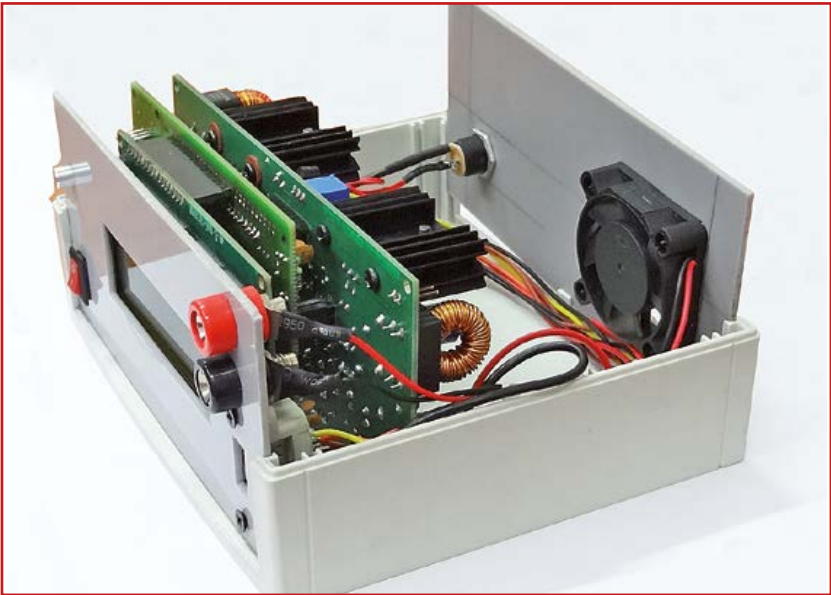
Figure 3. L'intérieur du coffret. Les trois cartes (LCD, Platino et carte d'alimentation) sont montées verticalement derrière le panneau avant.
