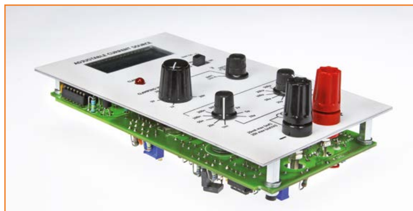
Figure 7. La carte et la face avant sont reliés par des entretoises hexagonales procurant un assemblage solide.
