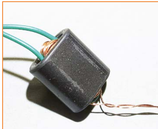
Figure 13. Une ferrite à deux trous comme transformateur de courant.
