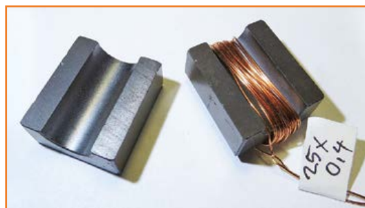
Figure 15. Un noyau de ferrite en deux parties à assembler après bobinage.
