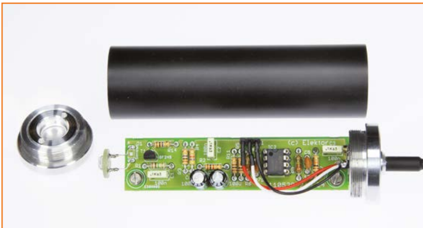
Figure 5. Le coffret de la sonde, du fait maison aussi.
