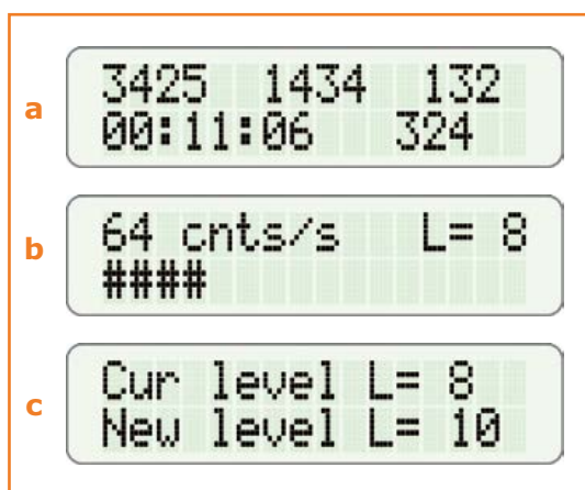
Figure 3. a) l'écran des mesures, b) le mode intensité de rayonnement, c) le réglage manuel du niveau de départ.
