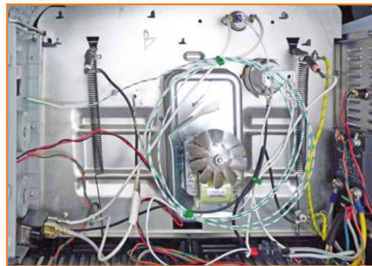
Figure 8b. J'ai gardé le thermostat de sécurité de type Klixon d'origine.
