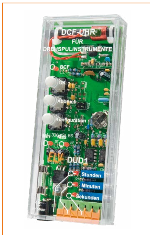
Figure 7. La platine enfermée dans le boîtier disponible en option.
