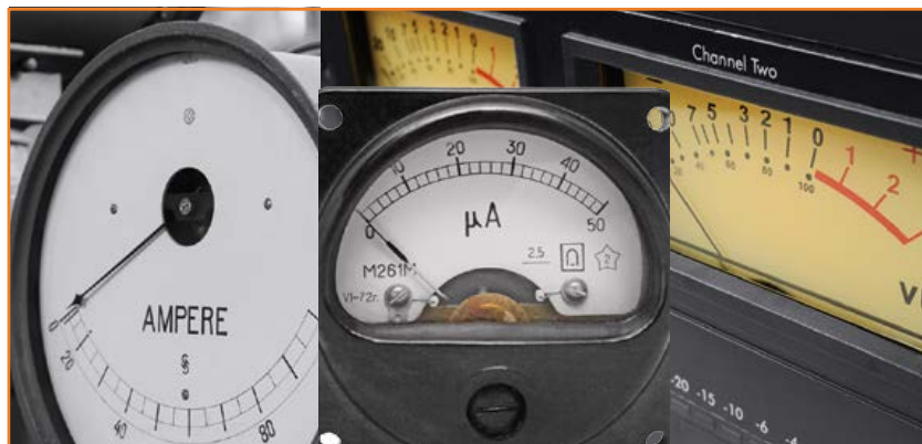
Figure 1. N'importe quel instrument à cadre mobile sans shunt interne peut servir dans l'horloge DCF.
