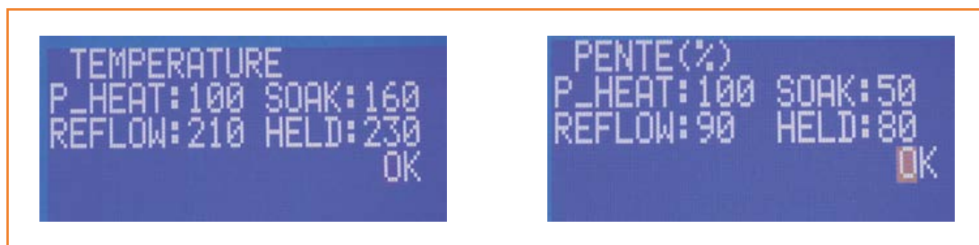
Figure 9. Visualisation des températures des phases (a) et des coefficients de montée en température (b)
