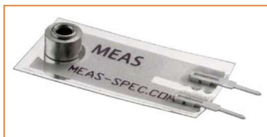
Figure 1. Ce transducteur piézoélectrique de Measurement Specialties produit une tension quand il se courbe, par exemple sous l'effet d'oscillations.
