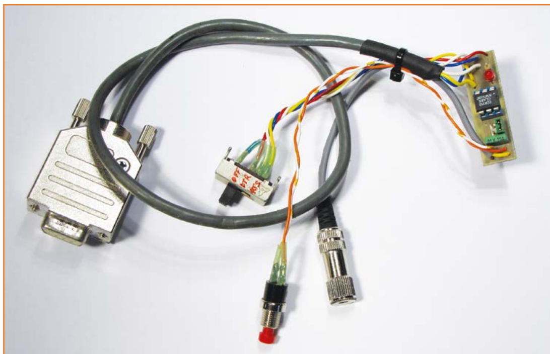
Figure 1. Un optocoupleur permet de garantir la séparation galvanique entre un PC et la radio qu'il commande.
