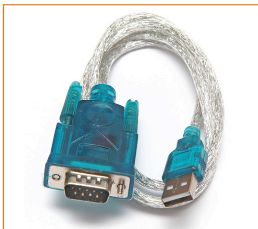
Figure 2. Et pour quelques euros, un adaptateur USB/sérieur. Dans la volumineuse fiche SubD se trouve un convertisseur actif.
