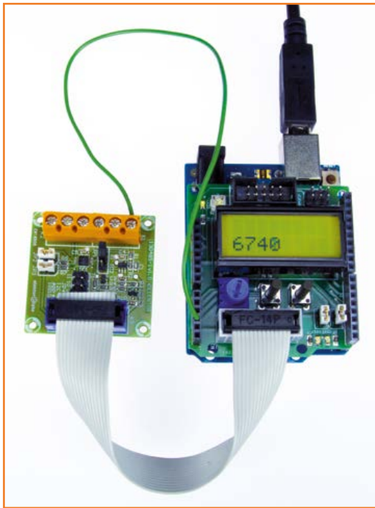
Figure 4. Un simple fil entre la broche 3 d'Arduino et l'entrée AIN0 du module CA/N et vous pouvez essayer l'application d'enregistreur de données.
