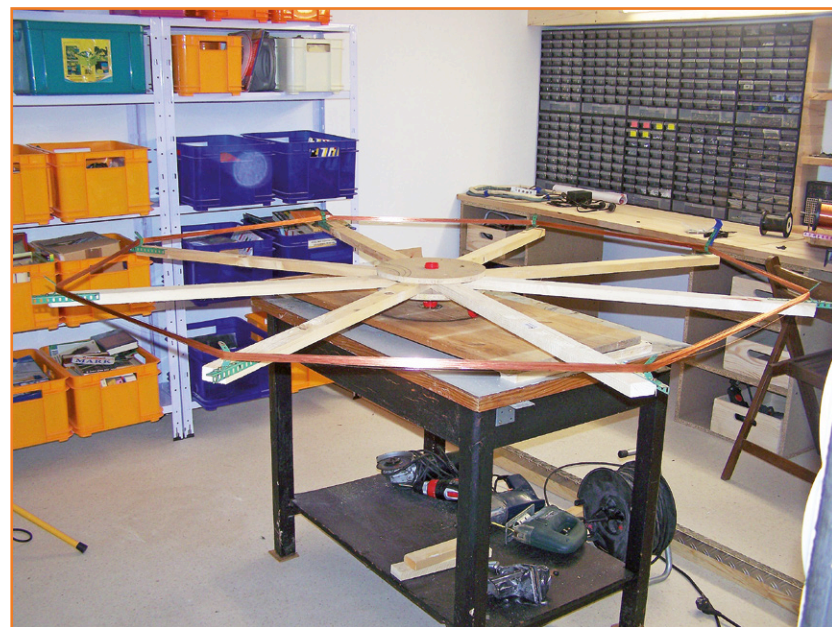
Figure 5. Ma bobineuse maison. En pratique, on peut se satisfaire d'un modèle plus rudimentaire.
