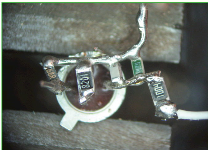
Photo 1. L'important pour obtenir un générateur à avalanche très performant est de réduire au maximum les inductances parasites. Ici les composants CMS sont directement soudés sur les pattes du transistor.
