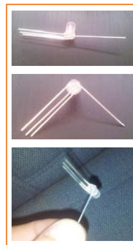
Figure 7. Comment plier les pattes des LED pour assembler le cube.
