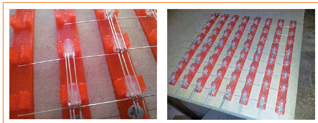
Figure 8. Le gabarit utilisé pour maintenir les segments de 8x8 LED afin de souder les anodes et les cathodes et créer les rangées et les colonnes.
