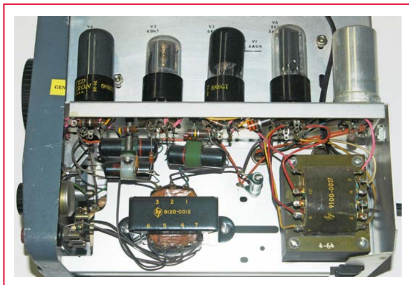
Figure 6. Les sections amplificateur et alimentation du HP 200AB.
