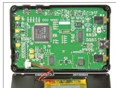
Figure 2. Au cœur du Nano. Le processeur ARM se charge de presque tout.
