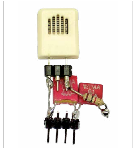
Figure 7. Le mini-shield avec capteur embarqué.
