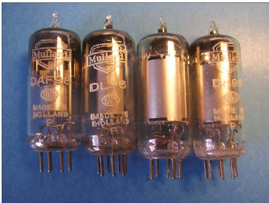
Figure 10. Les tubes extraits du P87BQ sont estampillés Mullard, B.V.A. ( British Valve Association ) et fabriqués en Hollande. Une étrange combinaison !
