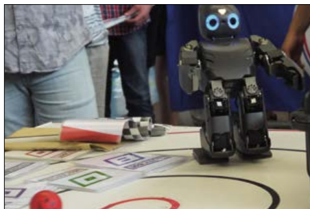
Figure 2 – Le robot Darwin (utilisé en lycée technique) suit la balle rouge grâce à sa caméra.
