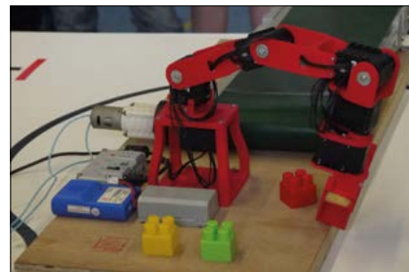
Figure 3 – Bras robotisé réalisé avec une imprimante 3D.
