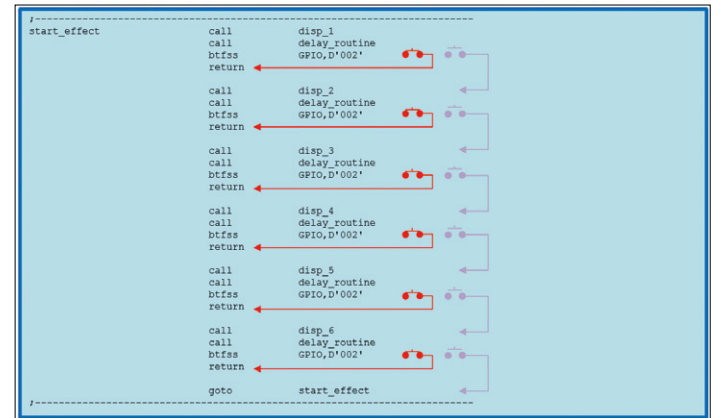
Figure 15. Code du dé électronique : production des chiffres dans la routine de « démo ».
