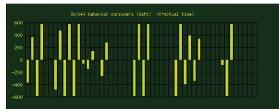
Figure 6. Brancher/débrancher un appareil permet de mesurer sa consommation.
