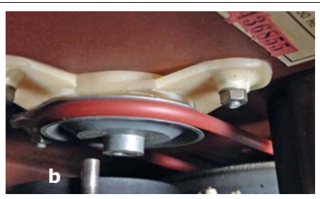
Figure 5. Assemblage mécanique de l'entraînement à friction du KC 1 (5a), courroie en caoutchouc et enrouleur (5b).
