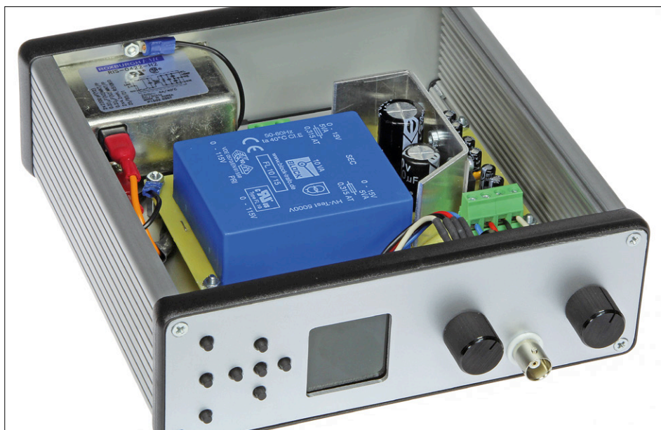
Figure 8. Le prototype construit par Jan Visser au labo Elektor. Découpes faites avec une machine-outil à 100 k€ des outils simples et de la patience.
