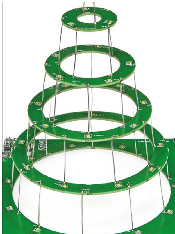
Figure 4. L'installation des morceaux de fil demande du soin lors du soudage pour obtenir un échelonnement régulier des anneaux.
