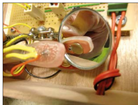
Figure 2. Les contacts à punaises sur les « bras » de la pince à linge (dans le miroir).
