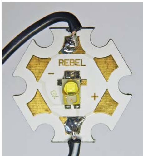
Figure 4. Une LED de 3 W sur un circuit imprimé avec noyau d'aluminium pour évacuer la chaleur.
