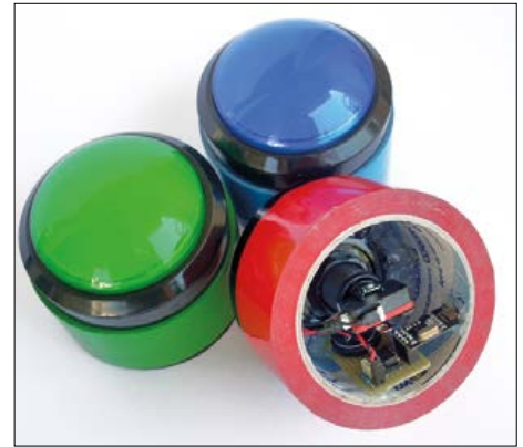
Figure 5. Fabriqué avec un empilage de rouleaux de ruban adhésif et un microinterrupteur de qualité industrielle, le bouton de quiz de l'auteur est dans un boîtier solide décliné en trois couleurs.
