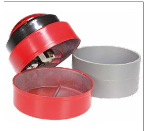
Figure 6. Variante élaborée, on peut construire un bouton à toute épreuve avec des morceaux en PVC et un gros bouton-poussoir de Sparkfun illustrés ici.
