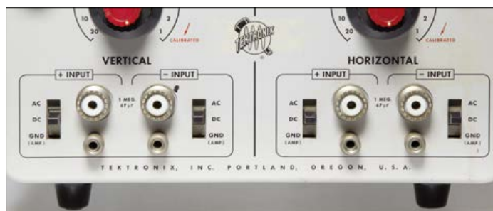
Figure 1. Pas si courant que ça : des entrées différentielles à la fois pour H et V. Idéal pour une visualisation X-Y et des mesures non référencées à la masse.
