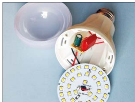
Figure 12. Vie intérieure d'une lampe à LED bon marché : condensateur série, diode, condensateur de découplage et tube à décharge. L'inscription dit : 7 W seulement, au lieu des 10 W annoncés !
