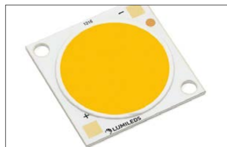
Figure 4. LED d'ultra haute puissance actuelle, modèle LUXEON CoB 1216 . Sur un support en céramique, de nombreuses LED bleues montées en série sont recouvertes d'une couche de phosphore commune. Les LED émettent un incroyable flux lumineux de 15 000 lm.
