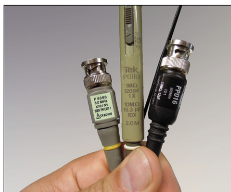
Figure 2. Ces sondes ont une bande passante maximale qui va de 2 à 300 MHz.
