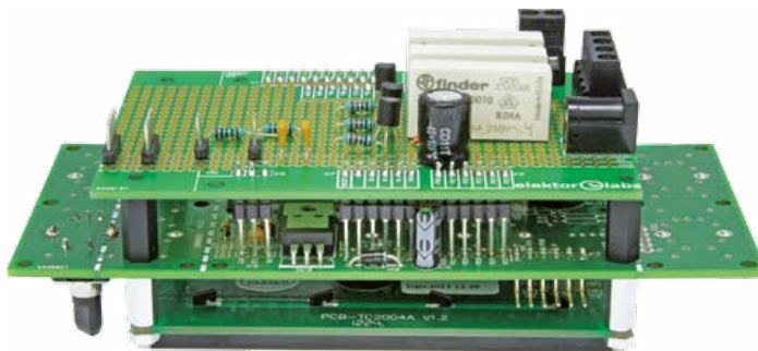
Figure 6. La carte d'extension Platino, pratique pour expérimenter et assembler des applications maison.
