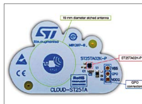
Figure 2. Où puiser dans l'intelligence de la carte d'évaluation CLOUD-ST25TA.
