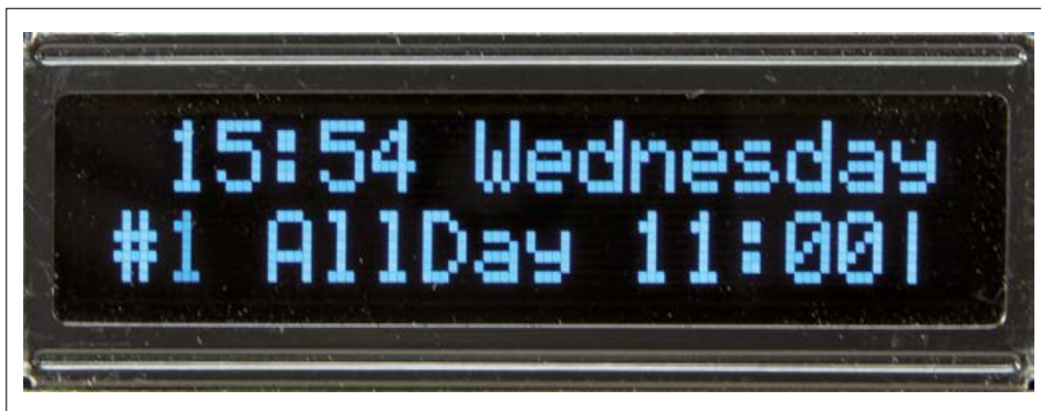
Figure 2. Appuyez sur S1, vous verrez à la deuxième ligne de l'afficheur le menu de réglage des alarmes.
