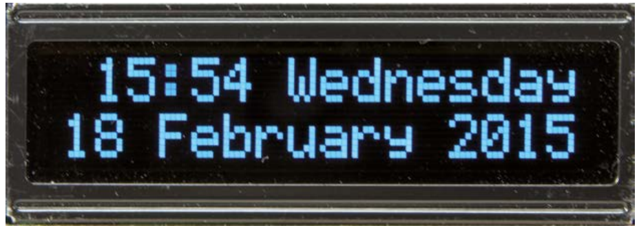
Figure 3. En temps normal, l'afficheur contient l'heure exacte et la date. Le logiciel concerné est disponible en quatre langues.
