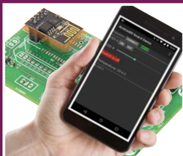
ESP8266 sur la carte d'entrées/sorties Android
