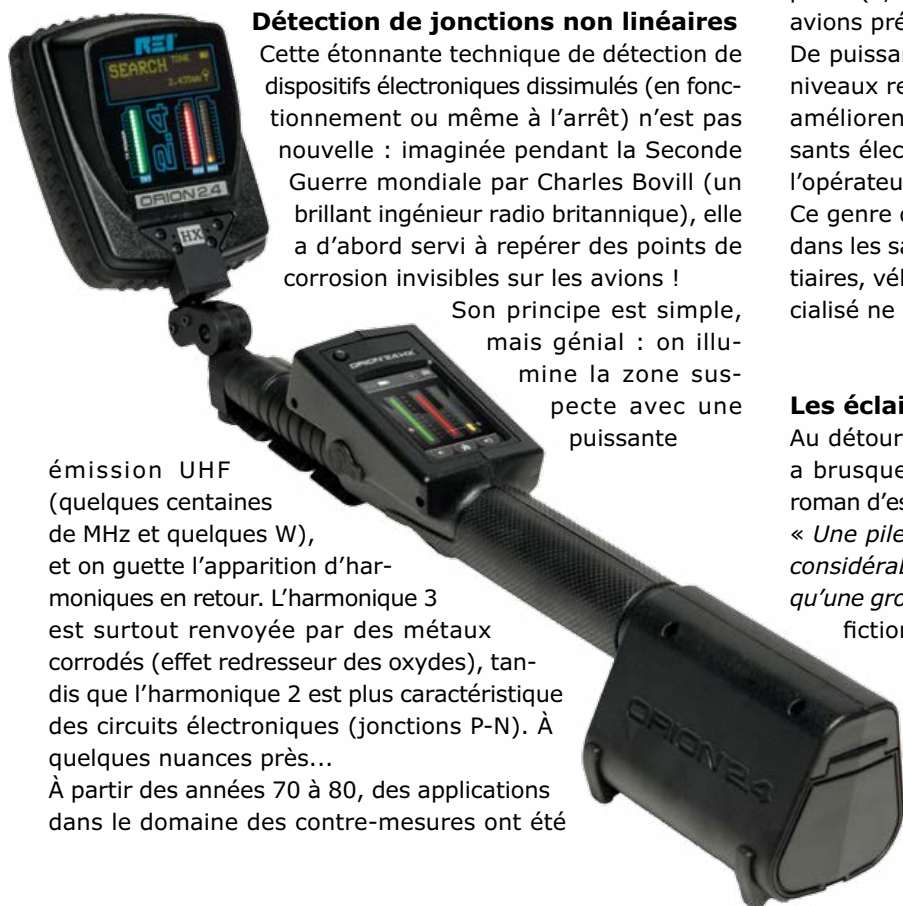
Figure 2. Détecteur de jonction non linéaire pour dénicher tous les circuits électroniques, même s'ils sont éteints.
