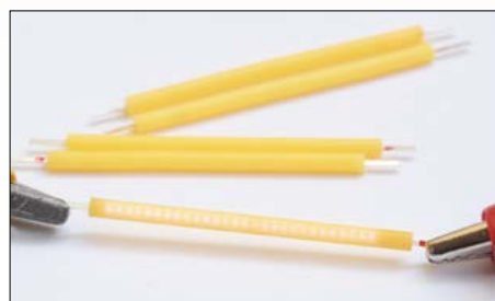
Figure 3. Lorsque le courant est très limité, on peut voir les différentes LED sur le substrat.
