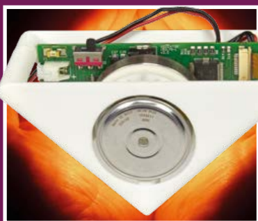
i-Pendulum tient en équilibre et se relève tout seul
