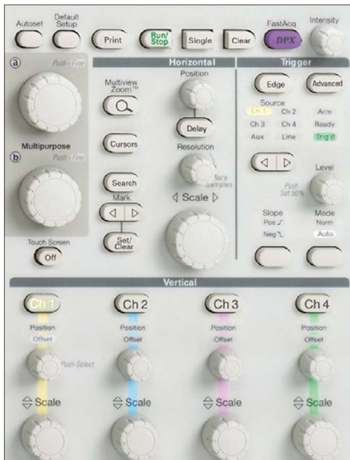
Figure 4. Il est très pratique de disposer de boutons de réglage en face avant pour chaque canal (photo : Tektronix).
