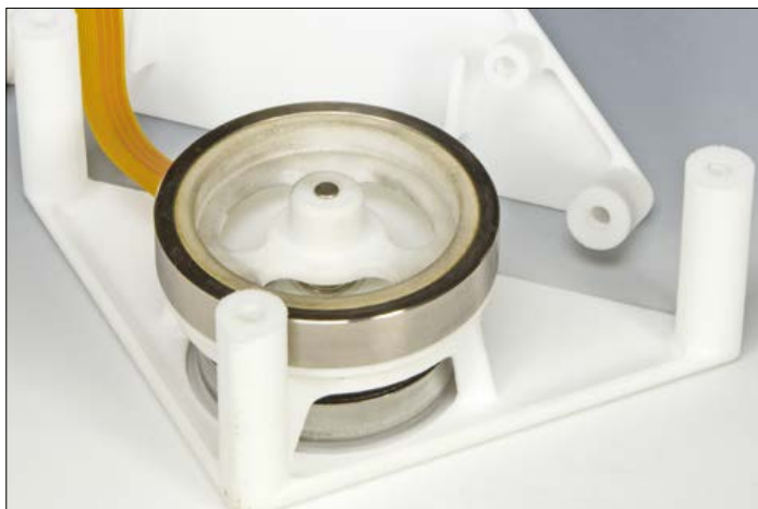
Figure 4. Roue d'inertie ajoutée sur le moteur.
