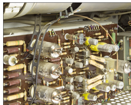
Figure 4. L'oscilloscope Philips PM3110 utilise du câble d'antenne symétrique pour attaquer les plaques de déviation verticale du tube cathodique. Ces courts raccords conduisent du 10 MHz sous 360 V Y1-Y2 max. à capacité constante.
