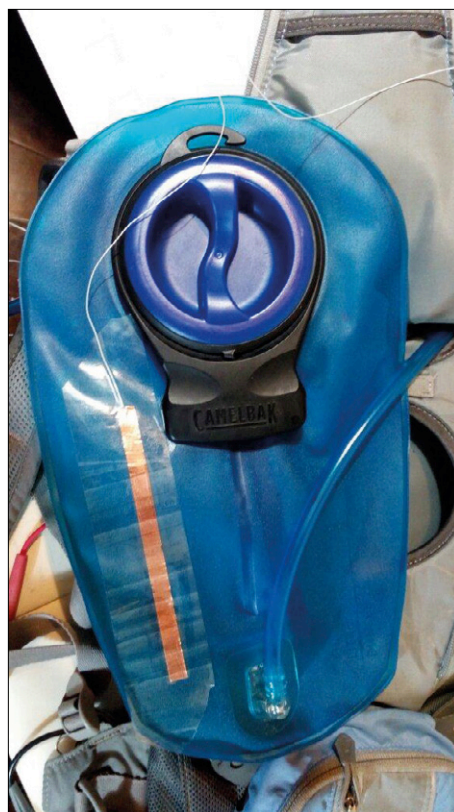
Figure 4. La poche à eau sur laquelle est fixé le capteur capacitif. Vous trouverez ce type de poche dans les magasins pour matériel de randonnée et de plein air.
