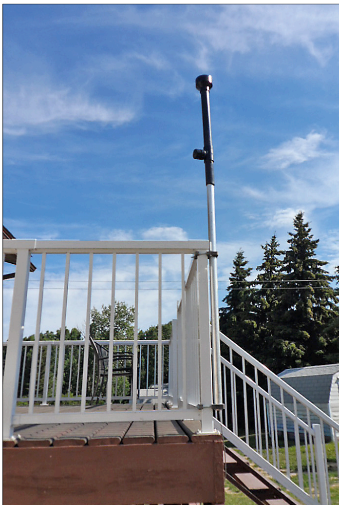
Figure 11. Le pluviomètre terminé. Il n'attend plus que la pluie.
