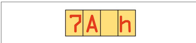
Figure 2. Affichage d'un octet sous forme hexadécimale sur l'afficheur à LED du premier article.
