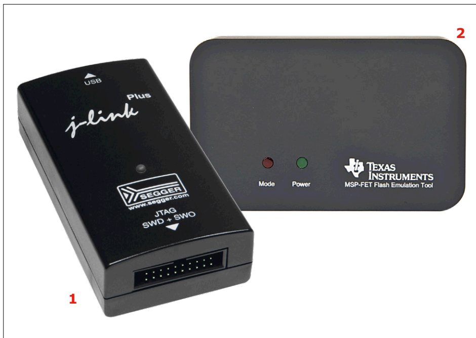
Figure 1. Le J-Link de Segger pour les microcontrôleurs ARM [1] et le MSP-FET pour la famille MSP430 [2]. Source : Segger et Texas Instruments
