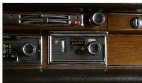
Figure 9. Version spéciale du boîtier de commande pour tableau de bord de Mercedes W108/W109.
