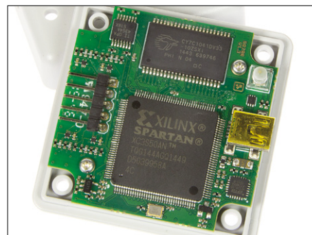
Figure 1. L'électronique du ScanaQuad est bâtie autour d'un circuit FPGA Spartan de Xilinx et d'une mémoire rapide.
