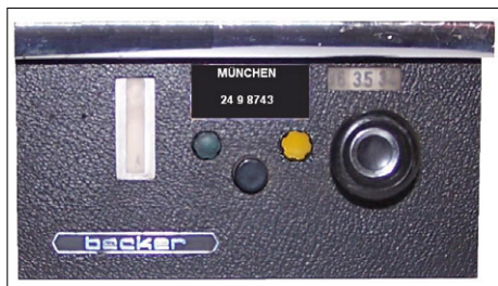
Figure 8. Boîtier de commande standard série AT400 « Becker » pour montage sur le tableau de bord. (Copyright oebL.de, merci !)
