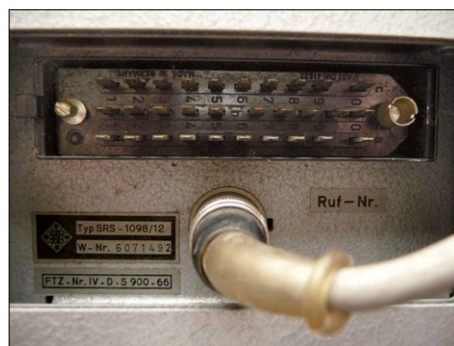
Figure 4. Les connecteurs de l'alimentation STV E 6/12 (4a) et de l'unité de sélection d'appels SRS-1098/12 (4 b). Ruf-Nr = identifiant de l'unité de sélection d'appels.
