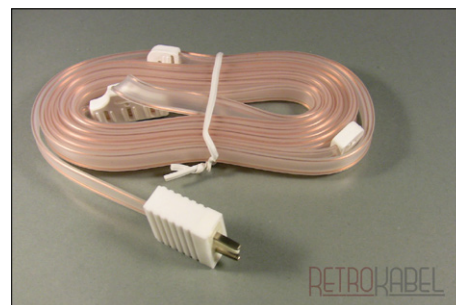
Figure 3. Une antenne intérieure de réception de la FM en VHF. Elle est faite de câble symétrique twin de 300 \Omega .
