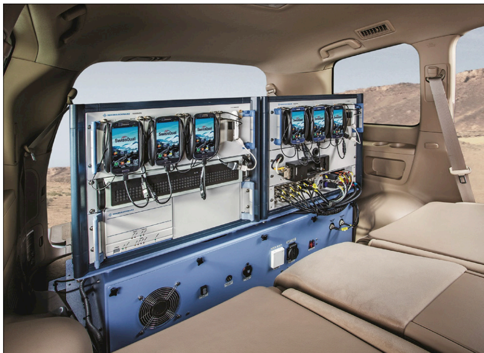
Figure 3. Appareil de mesure et d'essais utilisé pour analyser les performances d'un réseau et optimiser le service fourni à l'utilisateur.
