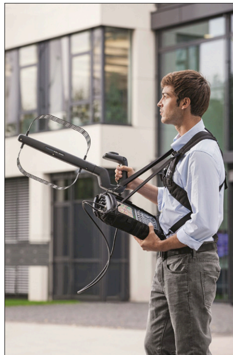
Figure 4. Les récepteurs mobiles à antennes directionnelles permettent de surveiller la qualité d'un réseau et d'identifier les interférences.
