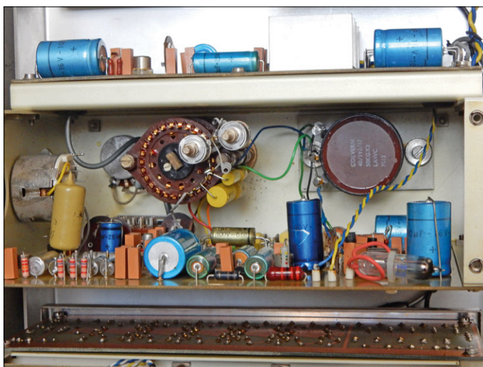
Figure 3. L'appareil pour émetteurs vu de dos : le tube en verre dans le coin inférieur droit du circuit imprimé contient la thermistance insérée dans la boucle de rétroaction.
