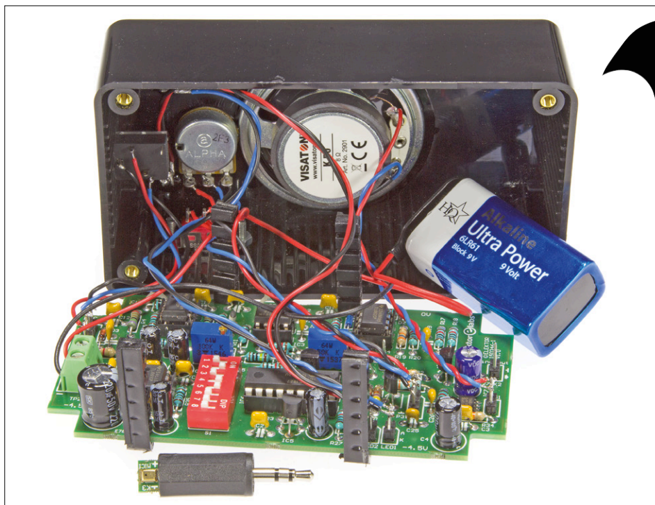
Figure 5. Le boîtier, ouvert pour montrer le câblage.
