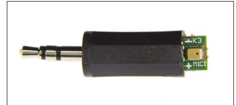
Figure 10. Le microphone MEMS peut être logé dans le manchon d'un jack de 3,5 mm.
