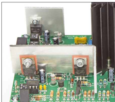
Figure 4. Il y a deux petites plaques d'aluminium de 1 et 2 mm d'épaisseur à faire soi-même, la plus petite pour IC3, la plus grande pour IC4, IC5 et T2.
