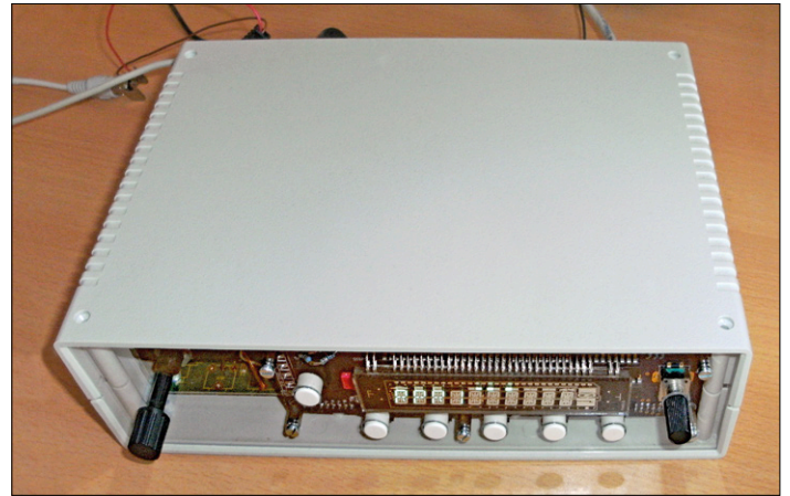
Figure 2. Couvercle dessus et micrologiciel dedans, la webradio de cuisine à VFD opérationnelle, l'électronique toujours visible derrière la façade en acrylique.
