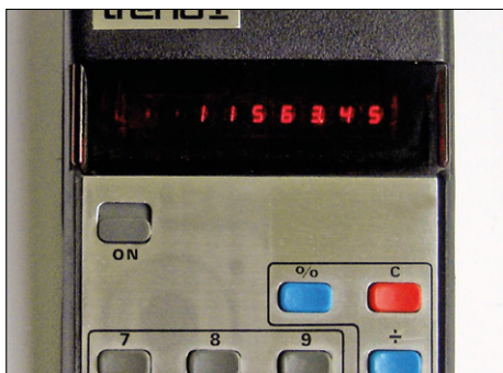
Figure 4. Les premières calculatrices pour le marché de masse étaient équipées d'afficheurs à 7 segments rouges lilliputiens (source : Erhaka, Wikimedia Commons).
