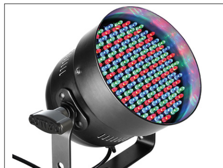
Figure 10. Projecteur de scène à effets du type CLP56RGB05PS de Cameo avec 151 LED de couleur et une puissance de 30 W sous 220 V. Ce projecteur est équipé d'une interface DMX pour la télécommande ainsi que d'un microphone intégré pour permettre des effets d'orgue lumineux.
