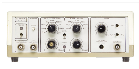
Figure 1. Commençons par l'ABS : générateur d'impulsions, au milieu des 80. Il manque un bouton sur la commande 0.1-1.0 Repetition Time.
