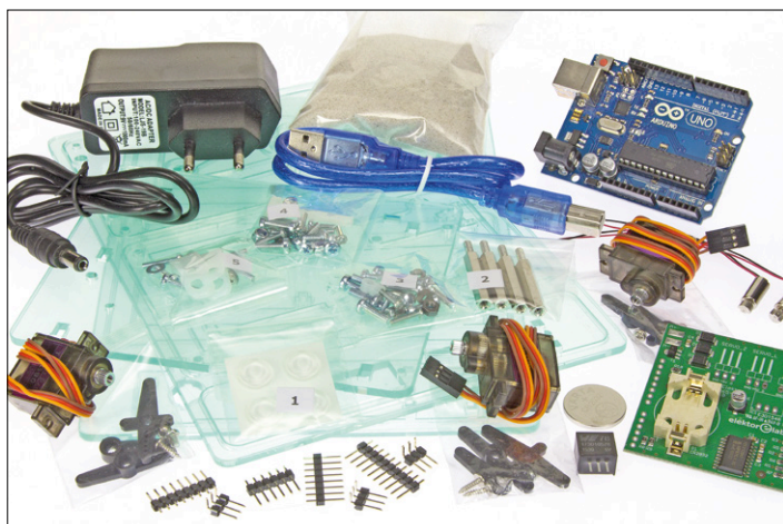
Figure 1. Le kit contient tous les composants nécessaires, même un adaptateur secteur. Il suffit dès lors de programmer l'Arduino avec le logiciel disponible gratuitement.
