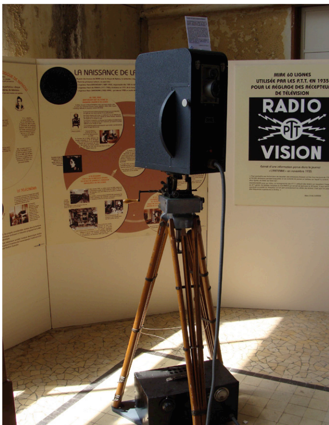
Photo 5. Caméra mécanique Barthélémy de 1931 à 30 lignes à disque de Nipkow (16 images/s au format 24 x 30 mm).
