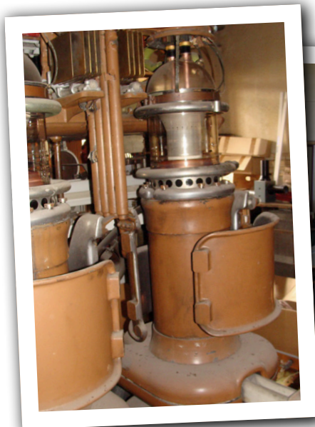
Photo 12. Lampe d'émission du bâtiment B, étage final de puissance de l'émetteur de 120 kW équipé de deux lampes SFR3055 (les plaques que l'on distingue ne sont pas les condensateurs d'accord de plaque, mais les condensateurs de neutrodynage).
