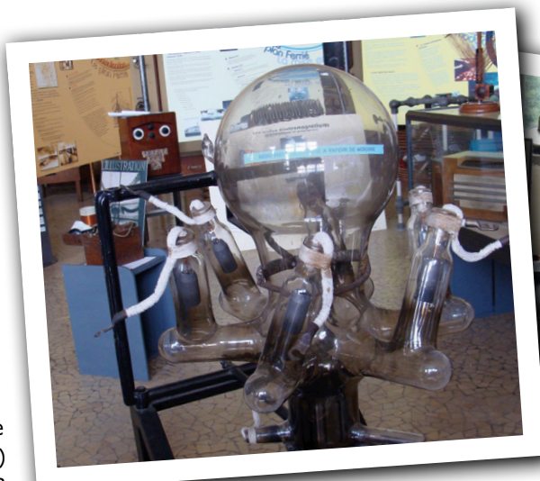
Photo 10. Redresseur à vapeur de mercure hexaphasé, utilisé pour les redresseurs de polarité de grille (500 V) des tubes de puissance des émetteurs de 120 W.
