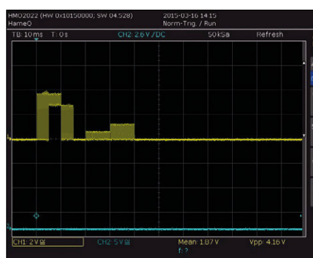
Figure 9. Réglage de l'échelle horizontale de l'oscilloscope avec l'option number . On peut voir un « n » avec deux marches, ce qui correspond à un écran avec douze divisions.
