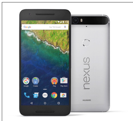
Figure 14. Google Nexus 6p : l'afficheur OLED de cet ordiphone bon marché compte 2560×1440 pixels.
