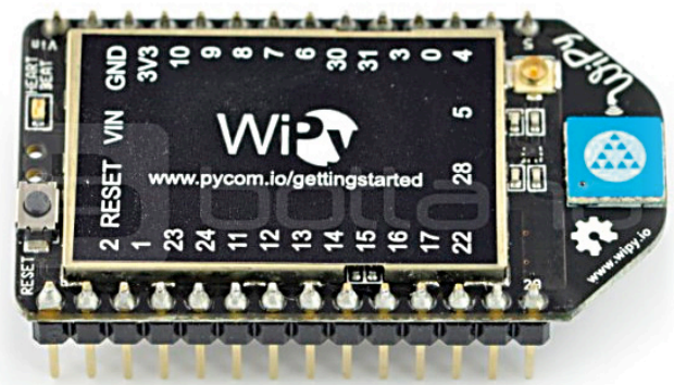
Figure 4. La WiPy est similaire à la carte NodeMCU basée sur l'ESP8266, mais avec un ARM Cortex-M4 CC3200 à la place.
