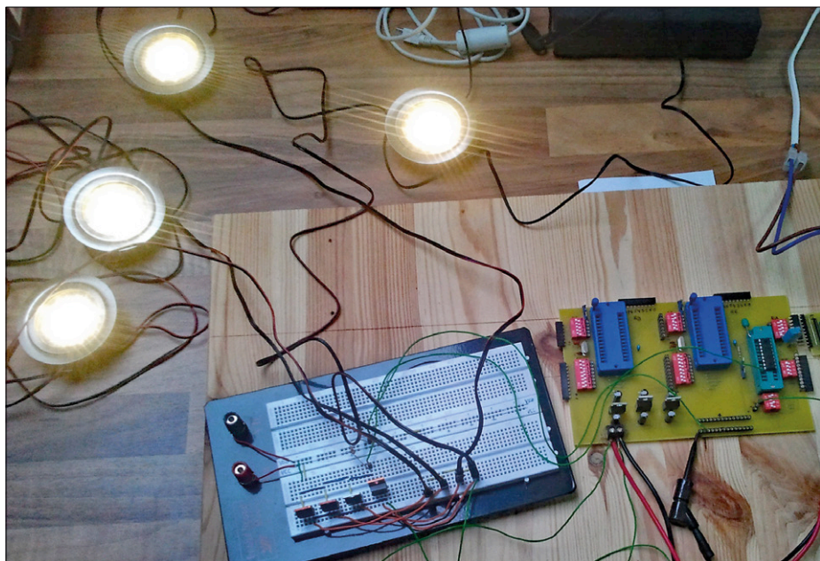
Figure 1. Montage de test « vite fait » de l'auteur : programmeur avec le microcontrôleur et quatre MOSFET sur une plaque d'essai.
