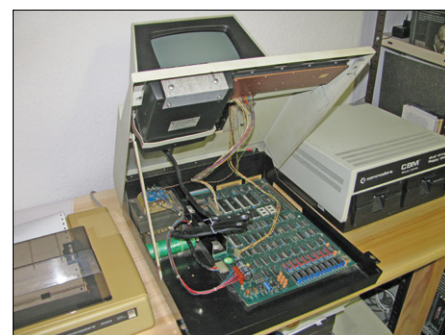
Figure 4. Il suffit de desserrer deux vis pour soulever le capot.
