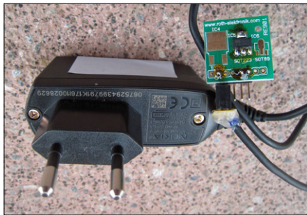
Figure 3. En utilisant un bloc secteur, Miroslav a construit (avec circuit de la figure 2) un premier chargeur Li-ion fonctionnel. Inconvénient : on ne voit pas ce qui se passe.
