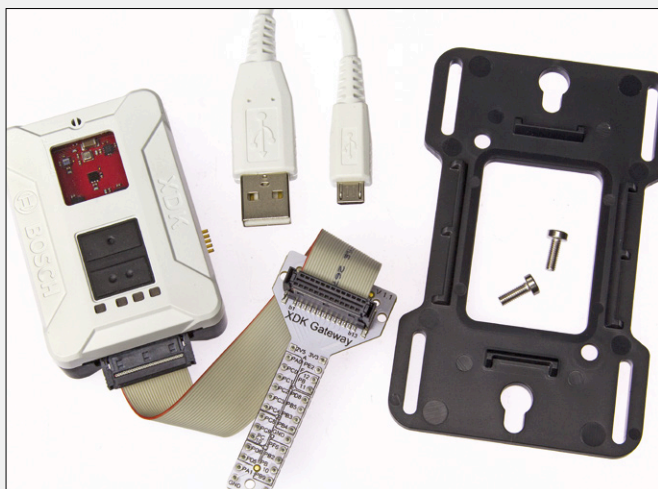
Figure 6. Les principaux composants du kit XDK110 ; un support (mural) est aussi disponible. La photo montre bien l'étonnante petitesse de l'objet.
