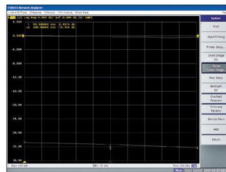
Fig. 7. Courbes de fréquences pour les atténuations minimale (0 dB) et maximale (31 dB).
