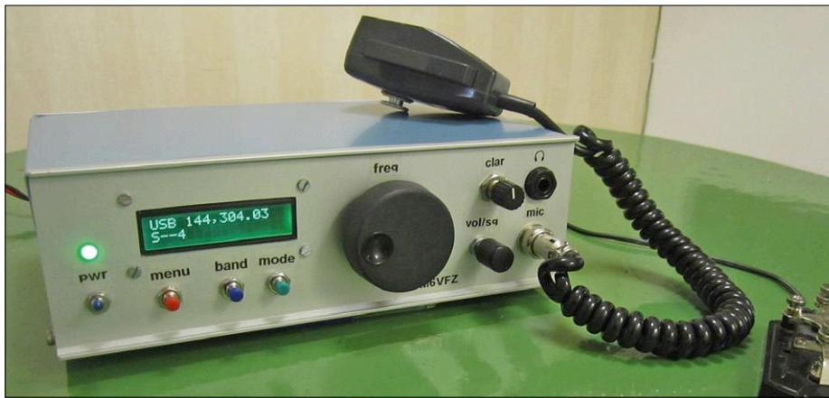
Figure 8. Le prototype construit par l'auteur, il opère en USB à 144 MHz.
