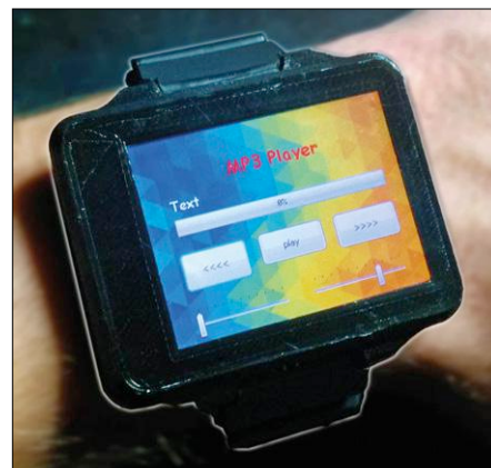
Figure 4. Grâce à une puce de décodage dédiée, la nWatch peut être utilisée en lecteur MP3.
