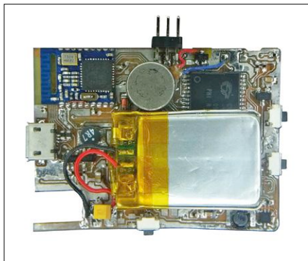
Figure 5. Pour réduire l'épaisseur de l'ensemble, la batterie LiPo est placée au-dessus de la puce SRAM.
