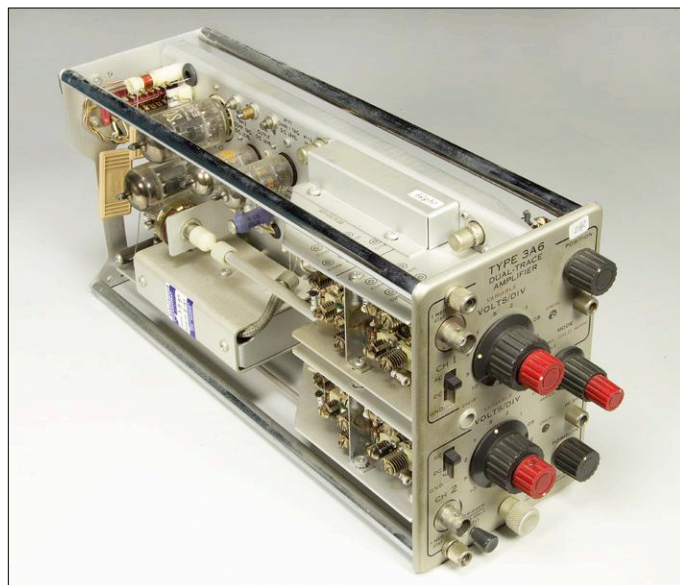
Figure 5. Le tiroir à double faisceau Tektronix 3A6. Deux d'entre eux dans un oscilloscope 556 vous donnent quatre traces précises de deux faisceaux d'électrons.
