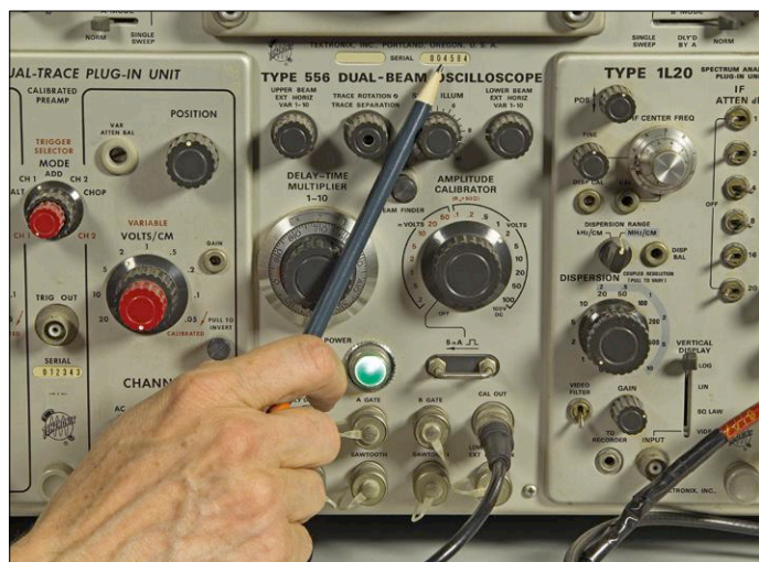
Figure 1. Zone centrale de la face avant de l'oscilloscope Tektronix 556 avec commandes et connecteurs communs aux deux faisceaux.
