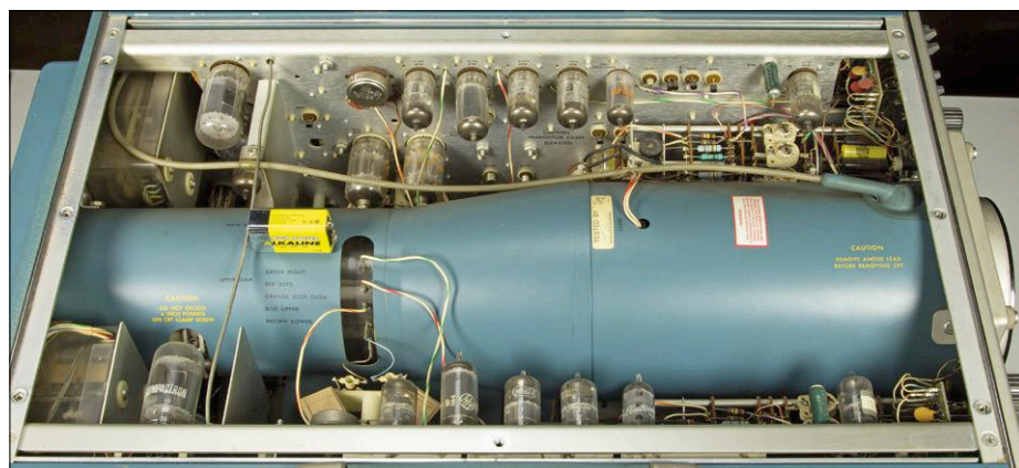
Figure 3. Vue intérieure du haut du Tektro 556 et son tube cathodique massif à double faisceau. Quel plaisir d'avoir maintenant des écrans LCD et LED sur nos oscilloscopes !
