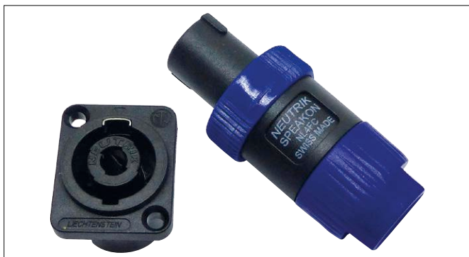
Photo 1. Le connecteur mâle Neutrik contrefait rentre bien dans le connecteur femelle Neutrik original, mais le verrouillage (une des caractéristiques principales de ce type de connecteur) est impossible !
