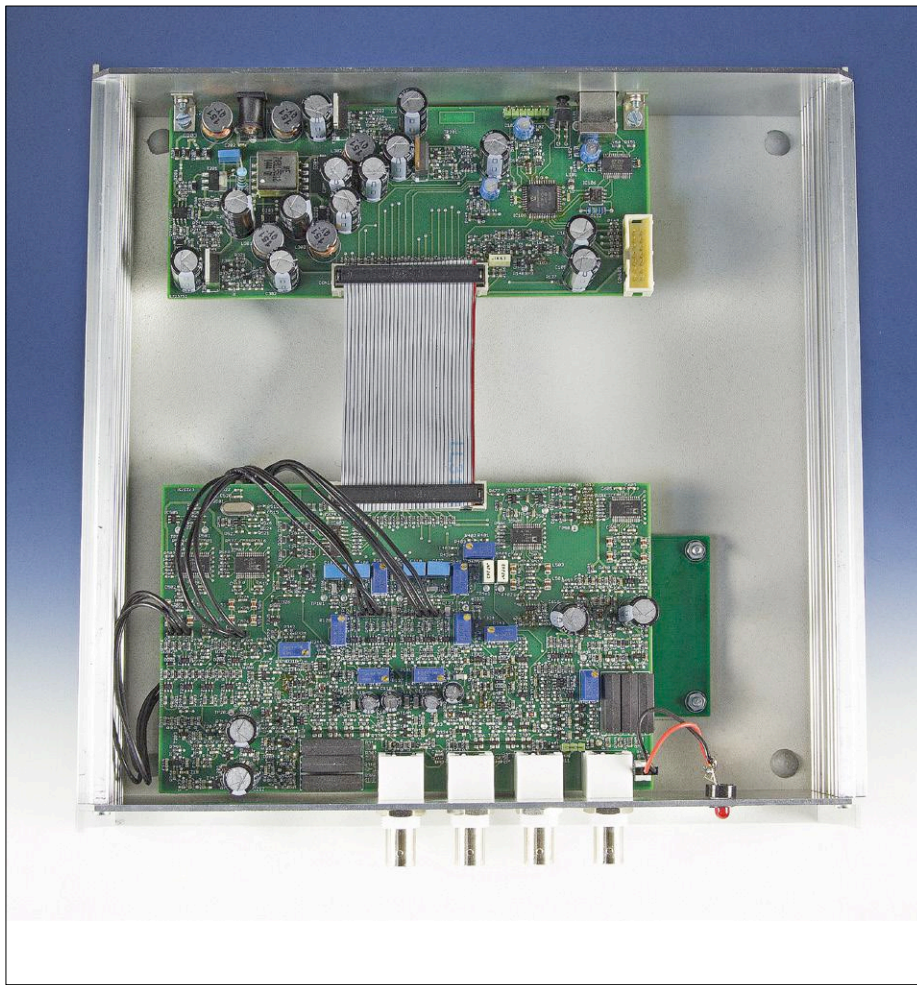
Figure 13. L'intérieur de l'analyseur, qui tient dans un boîtier de 25 cm de côté et d'une hauteur de 5 cm. Le circuit imprimé du haut supporte les alimentations, le microcontrôleur et les circuits de communication (FT232) ; le circuit imprimé du bas accueille la partie analogique, telle que décrite dans le texte.
