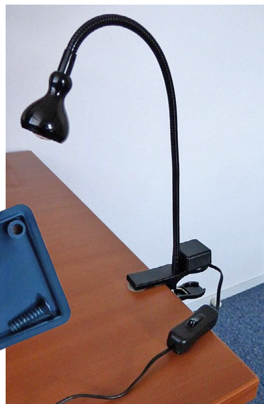
Figure 4. Le circuit peut prendre place dans un petit boîtier Hammond, qui sera fixé sur la pince de la lampe.
