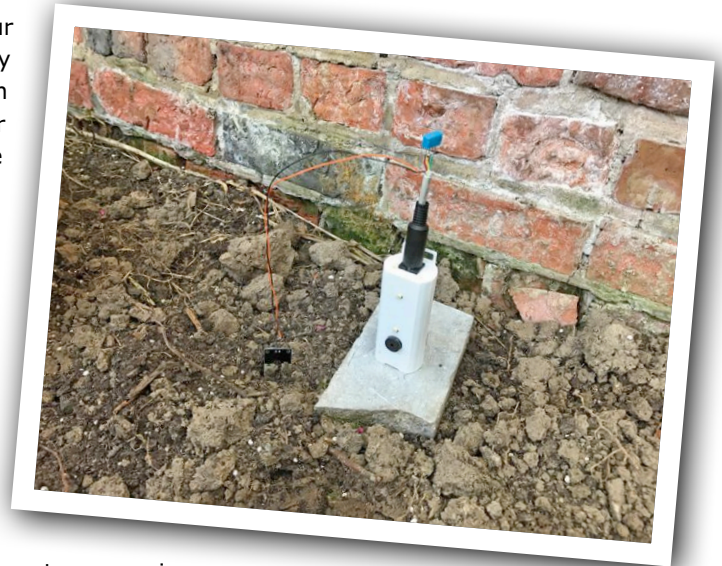
Figure 6. GoNotify occupé à surveiller l'humidité de l'air, la température et l'humidité du sol dans une serre.
