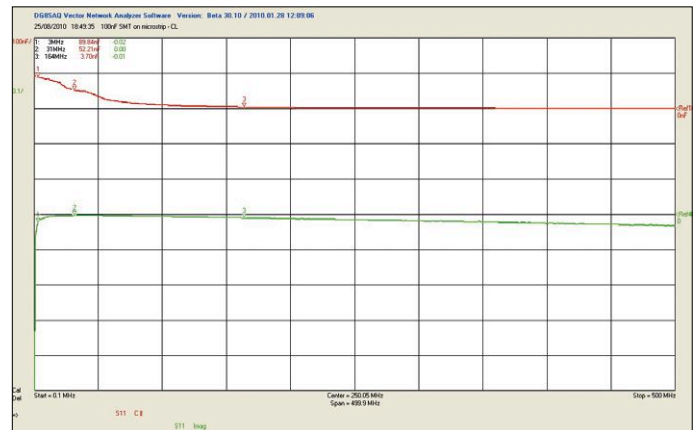
Figure 6. La mesure du condensateur CMS de 100 nF ne présente plus de résonance, mais sa valeur diminue lorsque la fréquence augmente. À 30 MHz, sa capacité est légèrement supérieure à 50 nF.
