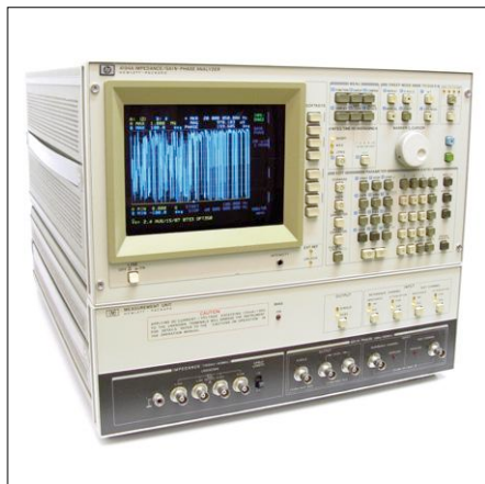
Figure 1. Le HP4194A pèse 37 kg et consomme 400 VA ; 36 pages sont nécessaires pour décrire ses caractéristiques. (Photo SGLabs)
