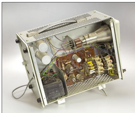
Figure 8. Ce n'est pas la place qui manque dans le BEM005. Notez l'utilisation de « cartes de câblages imprimées » en combinaison avec des tubes à vide, ce qui ne fonctionne qu'à condition d'utiliser des supports de tubes de qualité, de faire des soudures correctes et d'utiliser des pistes de cuivre massives.
