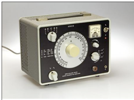
Figure 4. Générateur de signal BEM004. À noter : ce n'est pas un instrument commercial de MBLE, mais un appareil construit à partir d'un kit.
