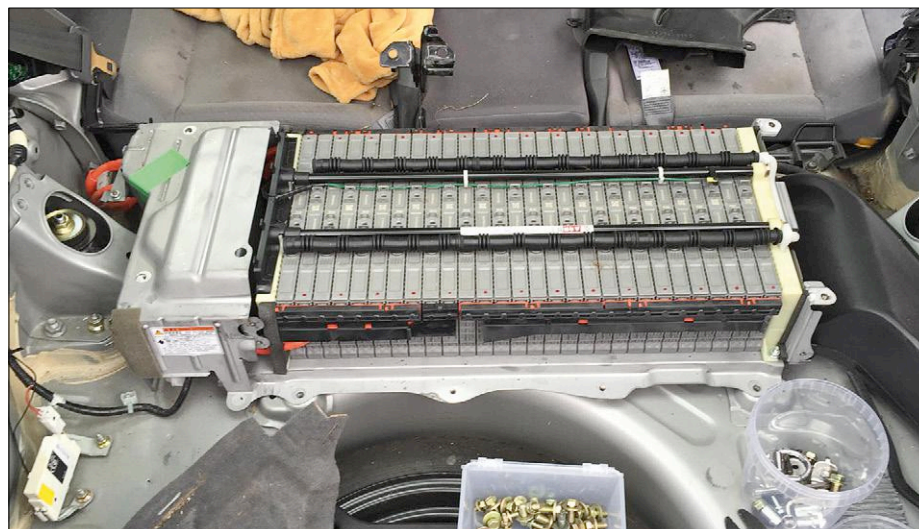
Figure 2. La batterie hybride ouverte de mon ancienne Prius II : 28 modules, avec chacun six cellules NiCd prismatiques de Panasonic de 1,2 V et 6,5 Ah. En série, ils produisent 201,6 V pour une valeur énergétique de 1,3 kW et un poids de 39 kg.
