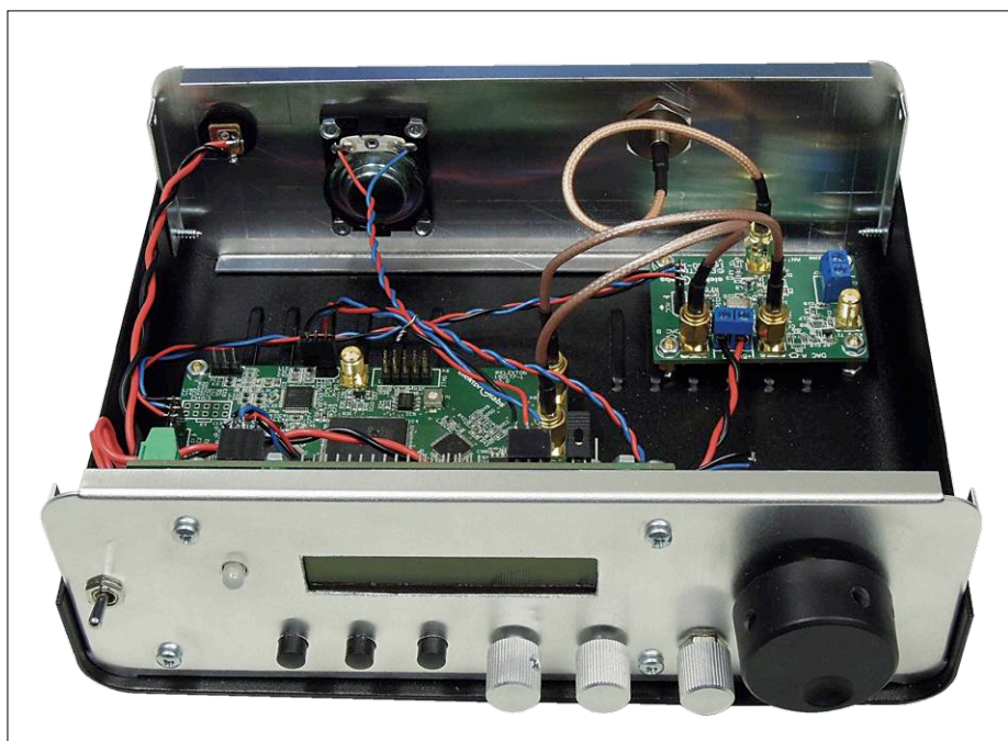
Figure 4. Coup d'œil dans le prototype terminé. Remarquez la manière dont le câble d'antenne est enroulé pour faire oublier qu'il est trop long.
