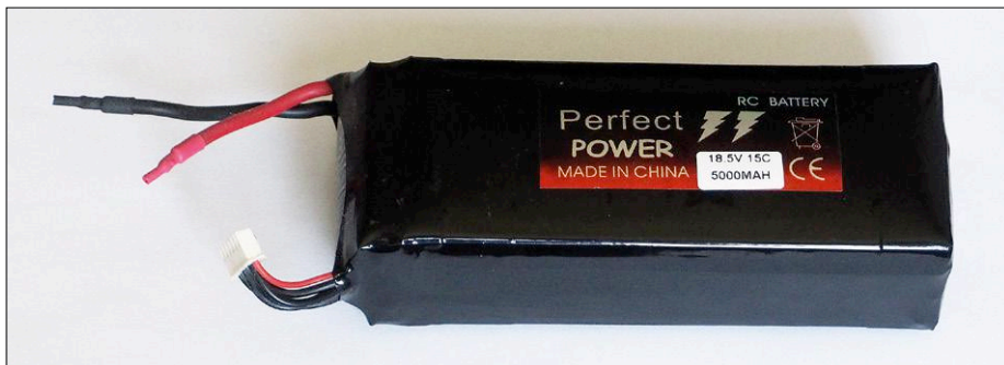
Figure 4. Batterie lithium-polymère 5s1p à 18,5 V et 5 Ah, et un courant de pointe de 15 C = 75 A pour modèles radiocommandés. Le petit connecteur à six broches est utilisé pour raccorder un équilibreur.
