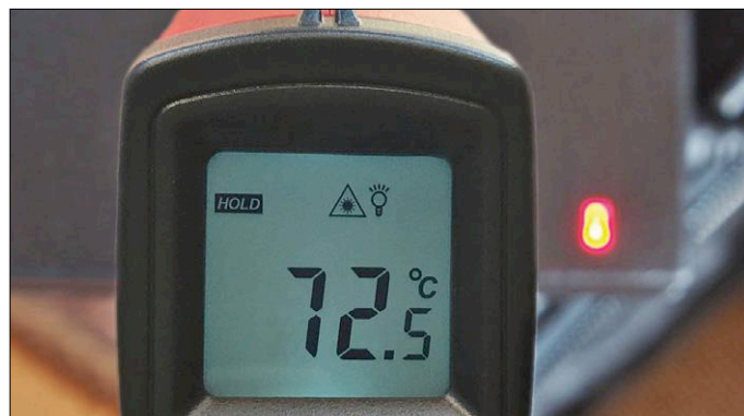
Figure 3. En peu de temps, le petit chargeur devient assez chaud.
