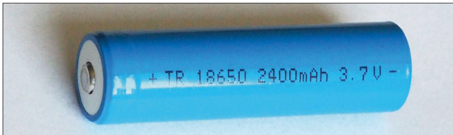
Figure 5. L'accu au lithium classique au format 18650 s'appuie sur la chimie \text{LiCoO}_2 et est de plus en plus utilisé dans des lampes de poche ou de bonnes lampes solaires pour le jardin par exemple. La tension nominale indiquée ici est de 3,7 V au lieu de 3,6 V.
