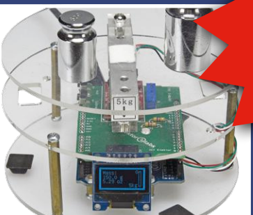
balance de cuisine : la recette jusqu'à 49,05 kg · m/s 2 avec Arduino
