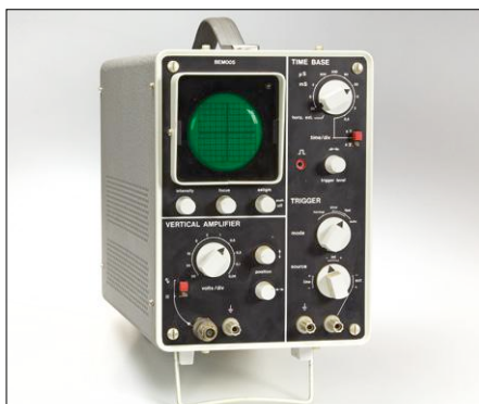
Figure 7. Oscilloscope BEM005. À noter : ici aussi cet instrument a été construit à partir d'un kit.
