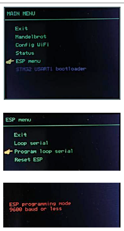
Figure 13. Copie des écrans pour régler la carte Nucleo comme interface de programmation du module ESP8266.
