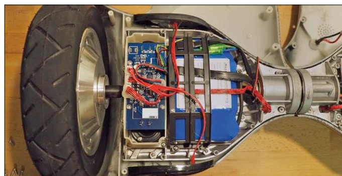
Figure 5. L'intérieur de l'aile gauche avec la pédale et la batterie.
