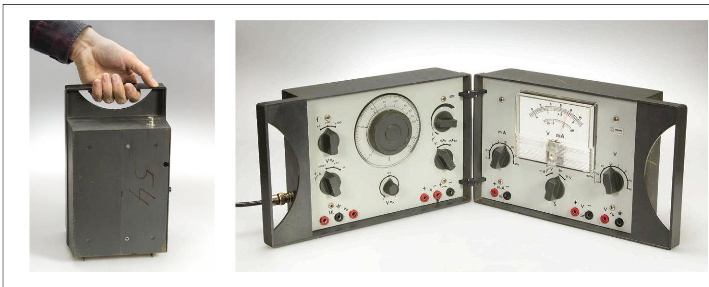
Figure 12. Avec une pincée de sel belge, le multi-instrument BEM045 de MBL peut être qualifié de labo d'électronique dans une boîte. Cependant il n'a jamais été proposé comme kit à assembler chez soi, mais il complétait le cours practronics de Philips sur l'ingénierie audio et acoustique.
