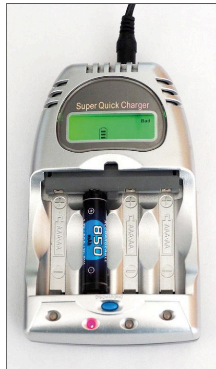
Figure 11. Chargeur rapide intelligent pour quatre cellules NiCd ou NiMh au formats AA et AAA jusqu'à 0,8 C, qui détecte même les cellules défectueuses. Une pression sur la touche bleue lance une décharge préalable.
