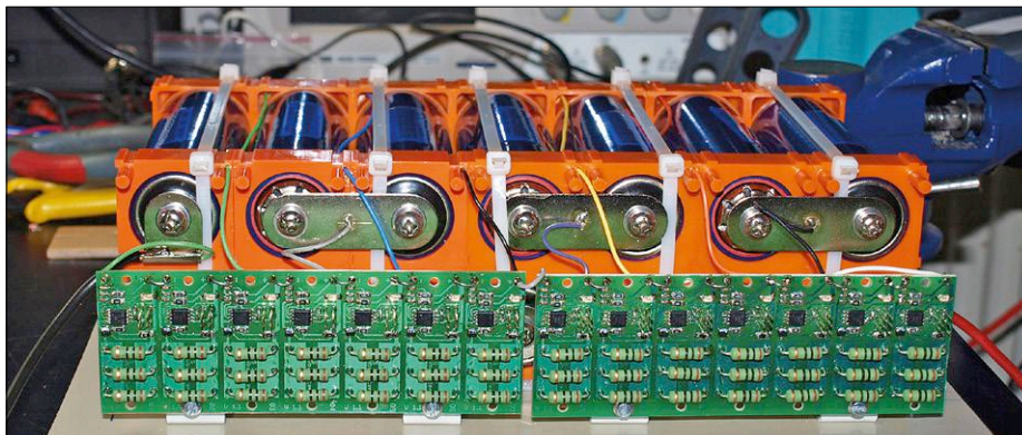
Figure 6. Le pack 45 V \text{LiFePO}_4 de mon clone de Segway : 14 cellules au format 38120 à 9 Ah et 10 C avec équilibreur (au premier plan).
