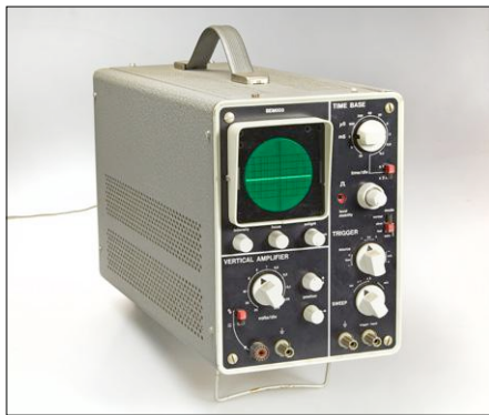
Figure 11. Le BEM003 était l'oscillo haut de gamme de BMLE ; cet exemplaire est malheureusement trahi par quelques pièces défectueuses, mais reste réparable.
