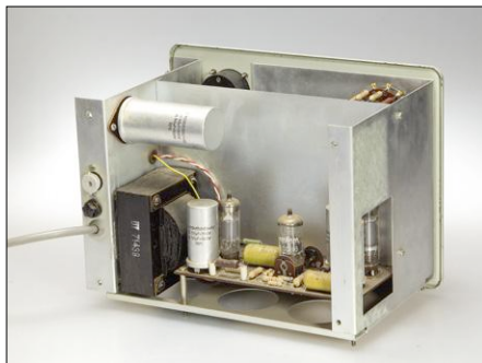
Figure 5. Plongée dans le BEM004 : techniques de construction classiques à base de tubes à vide et d'un châssis.
