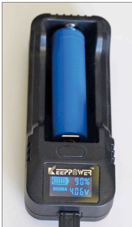
Figure 10. Petit chargeur bon marché pour cellules LiCoO 2 au format 18650 avec connecteur USB et affichage à LED organiques.
