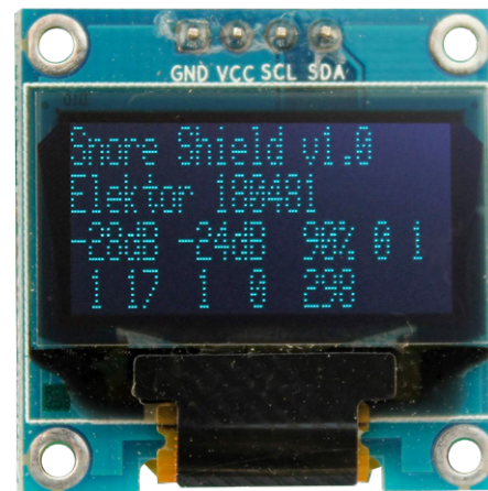
Figure 4. Pour l'instant, l'écran OLED du shield anti-ronflement ne donne que des informations pour le débogage (sans intérêt quand on tente de dormir). Ici, la valeur 298 sur la 4 e ligne est le nombre de secondes à attendre avant le retour au mode continu (le mode anti-ronflement a été déclenché manuellement).
