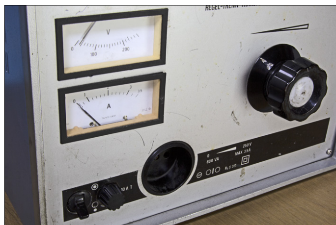
Figure 9. Qui aurait besoin d'un manuel d'utilisation ou d'un schéma si tout ce qu'il faut savoir est imprimé symboliquement sur la face avant du transformateur variable isolé RT 5A de Grundig ?
