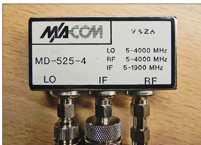
Figure 6. Pour mes expériences, j'ai utilisé ce mélangeur MACOM. Il est spécifié jusqu'à 4 GHz.
