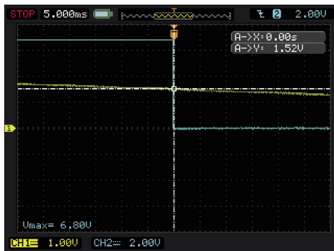
Fig. 9. Oscillogramme du seuil de commutation inférieur de la modification non-inverseuse.
