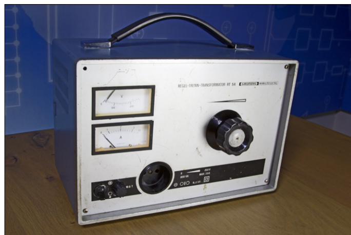
Figure 8. L'instrument RT 5A de Grundig Electronic des années 1970 combine un variac à un transformateur réglable, sortie isolée du potentiel du secteur. Important pour des dépannages sur les vieilles TV et les radios dont le châssis peut subir la tension de la phase (L). Remarquez que la prise de courant en face avant n'a pas de terre, ce qui est à la fois sage et souhaitable.
