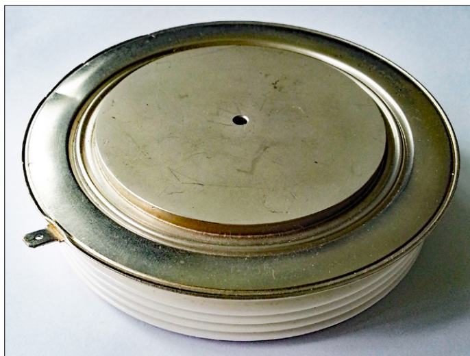
Figure 5. Le thyristor de grande puissance (4,2 kV pour 2,4 kA) a un diamètre de 11 cm (photo : Johnny.m76 / CC 3.0 [7]).
