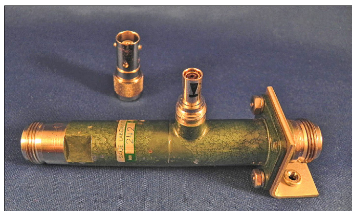
Figure 4. Un bel exemple de mélangeur à diode, extrait si je me souviens bien d'un analyseur de spectre HP8551 de 1965. La diode est la petite cartouche, encapsulée à l'intérieur du connecteur BNC visible à l'arrière.
