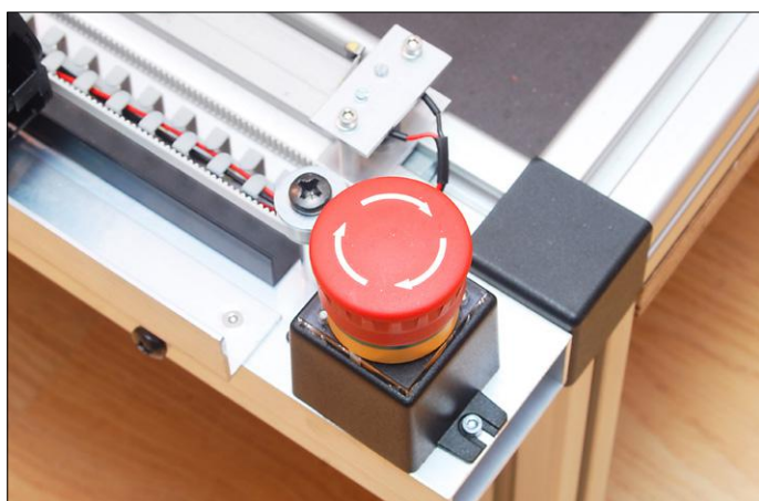
Figure 9. Un bouton d'arrêt d'urgence permet d'éviter une issue fatale à un foret en cas de mauvais fonctionnement.
