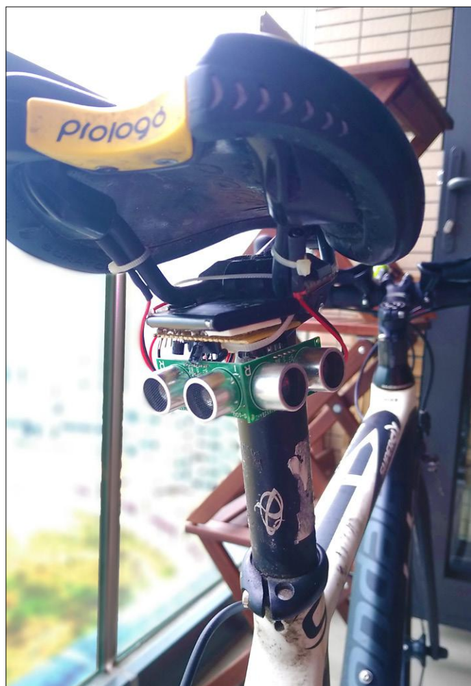
Figure 1. Prototype de l'auteur in situ, avec un capteur à droite et un à l'arrière. On distingue les fils de raccordement des vibreurs de part et d'autre de l'armature de la selle.
