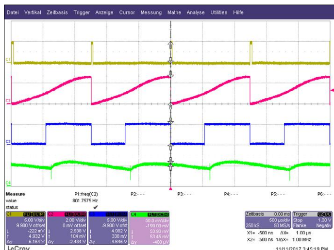
Figure 7. Signaux du circuit antirésonance pour un angle de pas de 15° et 901,75 Hz. C1 : impulsions de 30 µs sur SJ4 ; C2 : dents de scie sur SJ1 ; C3 : signal MLI sur SJ2 ; C4 : signal du shunt, U = f(IT) sur X2-6.
