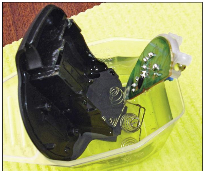
Fig. 2. Le porte-piles ainsi que les contacts et le circuit imprimé dans le bain rénovant de produit à vaisselle.
