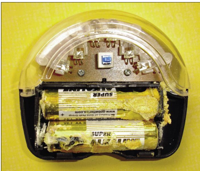
Fig. 1. Un feu arrière de vélo oublié pendant deux ans : les piles alcalines ont fui et les contacts ont été sévèrement rongés.
