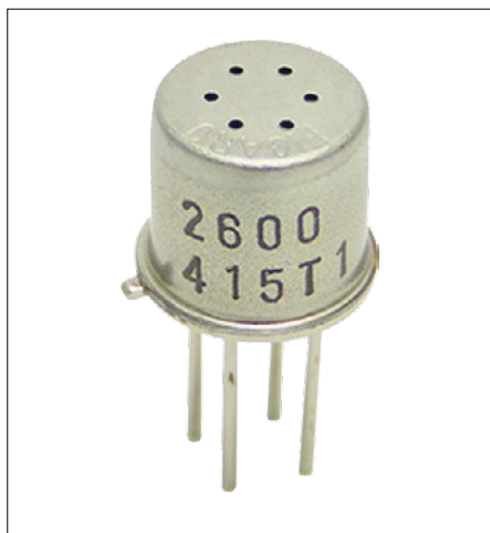
Figure 1. Le capteur Figaro de type TGS2600 détecte les gaz comme le méthane, le monoxyde de carbone, l'éthanol, l'hydrogène et l'isobutane.
