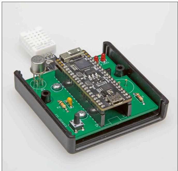
Figure 8. Le prototype de la carte des capteurs à présent au complet.
