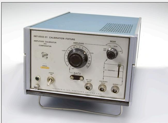
**Description :** générateur d'onde carrée à 1 kHz avec sortie précise en fréquence et amplitude. Plage de sortie de 200 mV<sub>cc</sub> à 100 V<sub>cc</sub> sur charge de 1 MΩ en 18 bandes. Boîtier Tektronix standard de 35 × 23 × 14 cm.
