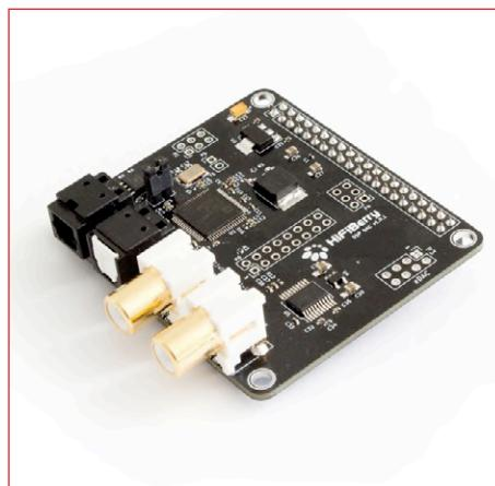
Le HiFiBerry DAC+ DSP est un convertisseur numérique-analogique à haute résolution pour le Raspberry Pi. Il combine un convertisseur N/A Burr-Brown à entrée et sortie numériques avec un puissant processeur de signal numérique.
