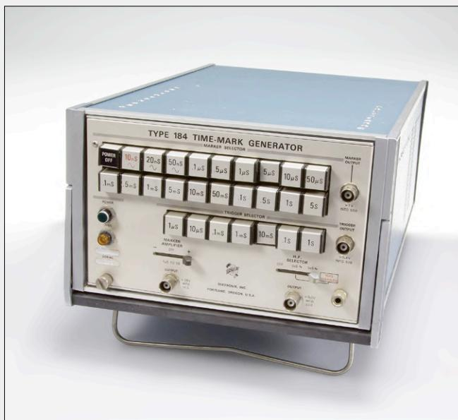
**Description :** offre un choix de 16 repères temporels et 5 intervalles de marques de sinus, pour une plage totale allant de 2 ns à 5 s. Impulsions de déclenchement pour l'appareil à tester entre 1 μs et 5 s. La précision du 184 est due à un quartz à 10 MHz confiné dans un four à température contrôlée. Boîtier Tek standard de 35 × 23 × 14 cm.
