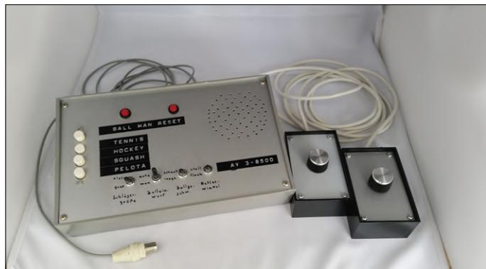
Figure 8. L'appareil de l'auteur d'après le guide de montage dans Elektor 6-7/1977.
