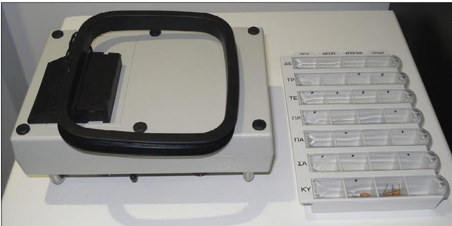
Figure 7. L'antenne-cadre montée à l'arrière du récepteur, en position repliée.
