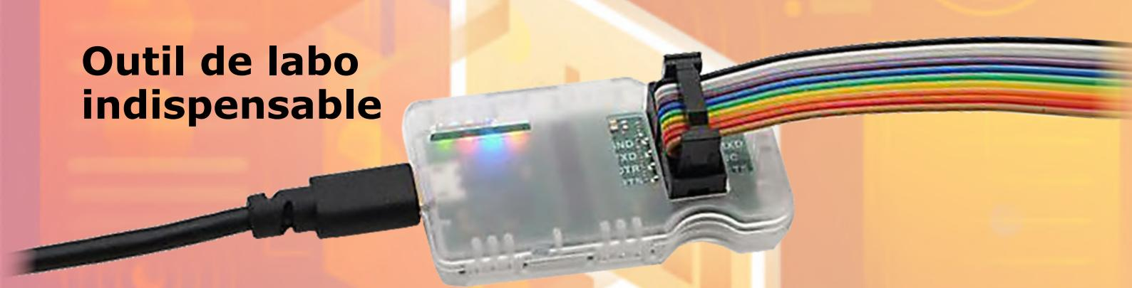
Fatigué d'avoir à jongler entre plusieurs convertisseurs série-USB en fonction des niveaux de tension de vos cartes ? Peur d'endommager le port USB de votre ordinateur à cause d'un court-circuit sur la carte cible ? Cet adaptateur USB vers UART-TTL isolé est pour vous. μArt fonctionne de 1,8 à 5,4 V, expose
