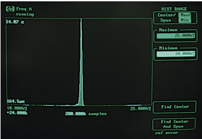
Figure 5. Dans le domaine de l'analyse des domaines de modulation, les faiblesses du RPi sous Raspbian sont clairement visibles.
