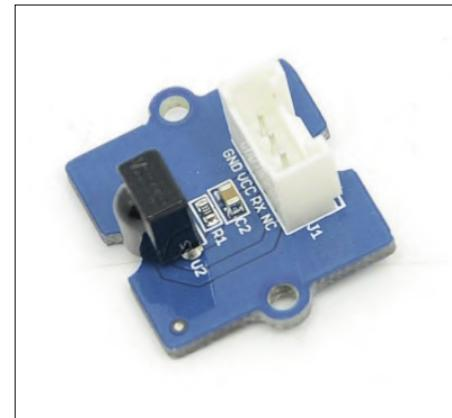
Figure 5. Récepteur IR utilisé par l'auteur.
