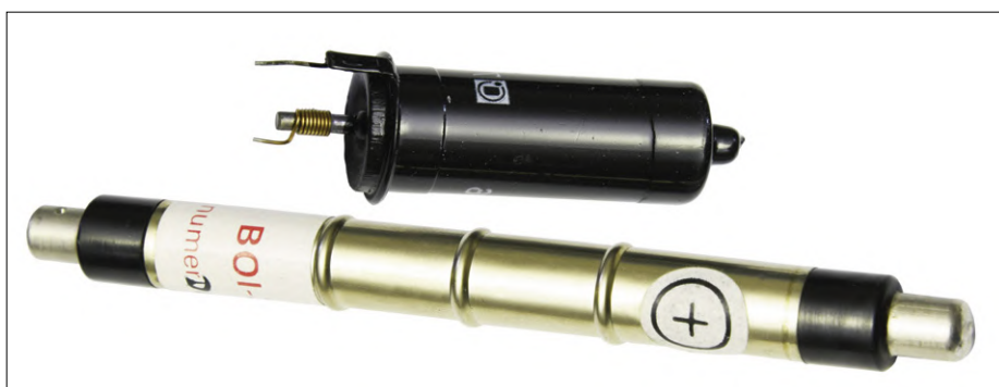
Figure 2. Deux exemples courants de tubes Geiger-Muller à chambre métallique.
