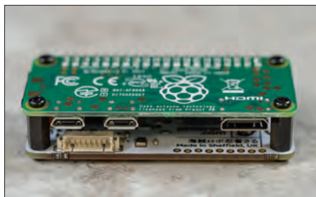
Figure 2 : Avec un Raspberry Pi Zero W, ça donne un sandwich compact.
