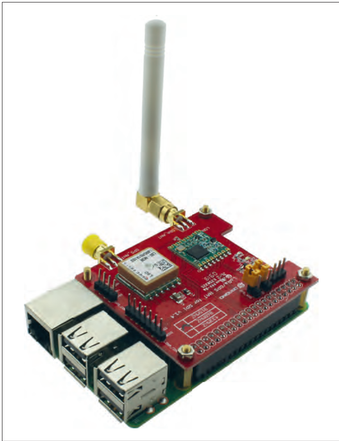
Figure 15 : Un Raspberry Pi avec Dragino-LoRa-HAT comme passerelle.
