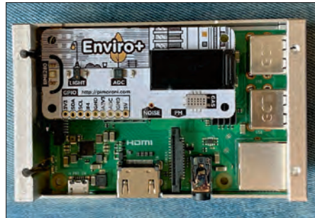
Figure 5 : Enviro+ avec son sparadrap isolant sur un Raspberry Pi 3B+.
