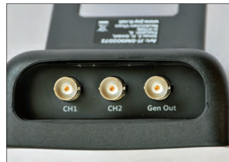
Le retrait profond des douilles BNC dans le haut du boîtier est pratique.
