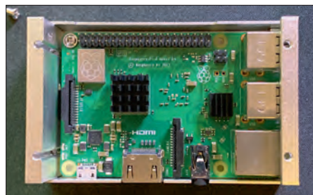
Figure 3 : Avec un Raspberry Pi 3 ou 4, le couvercle doit être retiré si la carte est installée dans un boîtier opaque ou même métallique.
