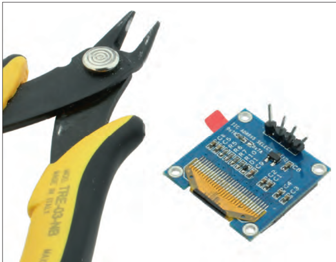
Figure 6 : Utilisez des pinces bien coupantes pour tronquer le plastique entre les broches.
