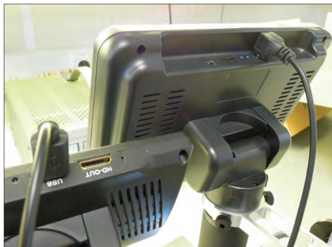
Figure 3. Grâce à la prise USB coudée, le câble s'utilisera moins vite.
