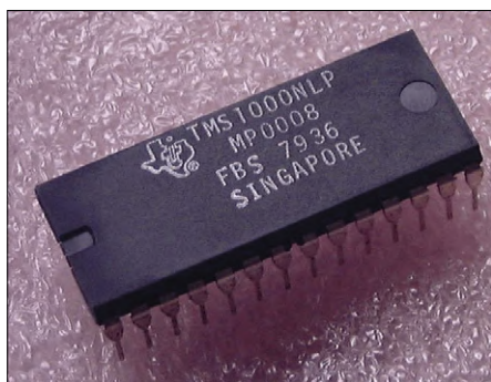
Figure 1. Microcontrôleur TMS1000 sur une seule puce. Image : Christian Bassow, Wikimedia Commons, CC BY-SA 4.0. https://upload.wikimedia.org/wikipedia/commons/d/d1/TI_TMS1000NP_1.jpg
