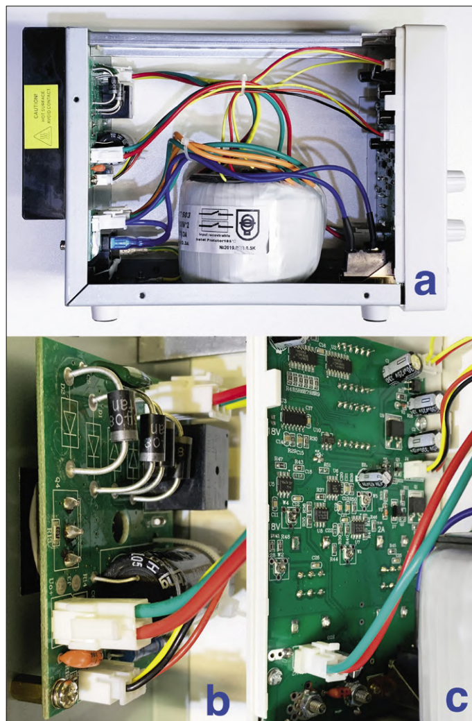
Figure 6. Intérieur de l'alim de labo PT 6080 A avec transfo de puissance, carte de puissance et section de commande avec CMS.
