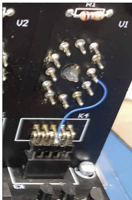
Figure 4. Connexion de l'élément «3» du tube Nixie V1 à la broche centrale sur le dessus de K4 ((la modification ne s'applique qu'aux PCB existants !)
