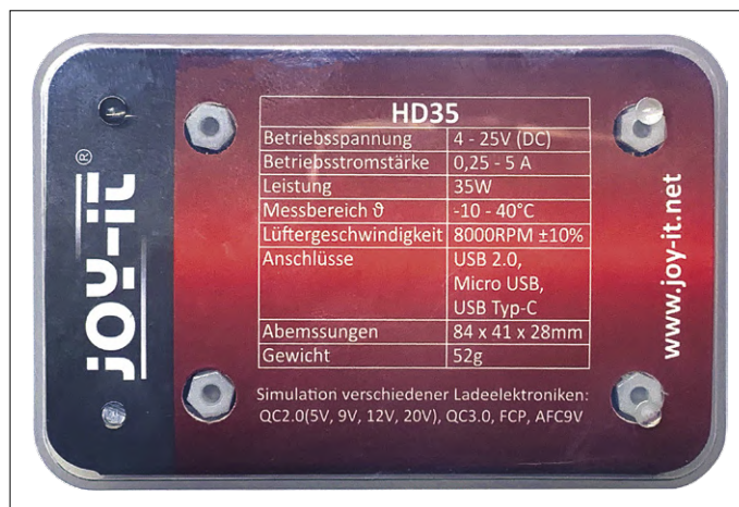
Figure 2. La boîte en plastique vue de dessous. C'est là qu'on trouve les caractéristiques techniques et l'URL du fabricant.
