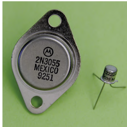
Photo 10. Comparaison de taille entre deux transistors. Astuce : pour éviter les reflets sur les surfaces métalliques, graissez légèrement ces surfaces.
