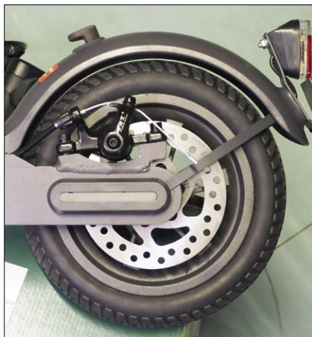
Figure 8. Roue arrière avec frein à disque et dispositif de blocage du guidon quand il est replié.
