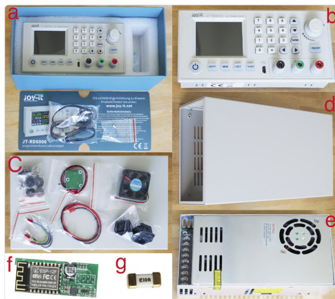
Figure 3. Le contenu de la mallette une fois déballé | 3a+3b : panneau frontal + sonde de température + fusible CMS | 3c : petites pièces mécaniques, ventilateur supplémentaire et carte de commande, câbles, fiche pour le cordon, interrupteur | 3d : boîtier en tôle d'acier | 3e : alimentation à découpage 400 W | 3f : module Wi-Fi ESP12F | 3g : fusible CMS de 10 A de rechange
