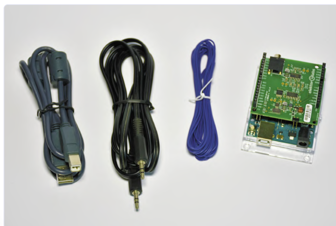
Figure 2. Pour utiliser ce kit, il vous faut un Arduino Uno, un câble USB, un câble audio et un peu de fil.
