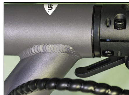
Figure 6. Soudure solide et mécanisme de pliage.
