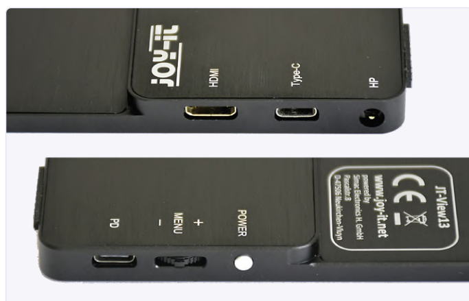
Figure 2. Les connexions sur le côté droit (en haut) et gauche (en bas) du Joy-View 13.
