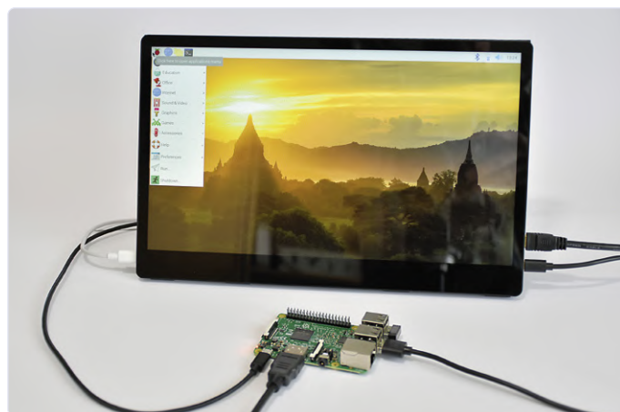
Figure 6. Le Joy-View 13 est ici connecté à un Raspberry Pi 3B sous Raspbian.
