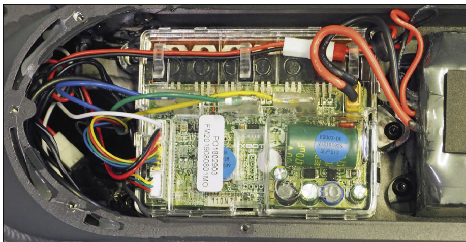
Figure 12. Les six MOSFETs de l'électronique encapsulée.
