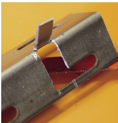
Photo 8. Pour éviter que la potence s'affaisse, sans serrage excessif de l'écrou M6 ni mécanique compliquée à réaliser et à régler à chaque déplacement, relevez un « doigt » de tôle de la cornière après deux traits de scie à métaux.
