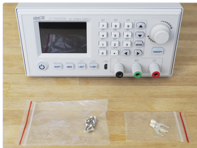
Figure 10. L'alimentation de labo assemblée. Il me reste huit vis à tête fraisée M3 et deux cosses.
