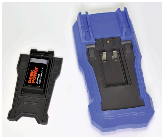
Figure 3. La pile de 9 V est montée sur un support séparé qui fait couvercle à l'arrière.
