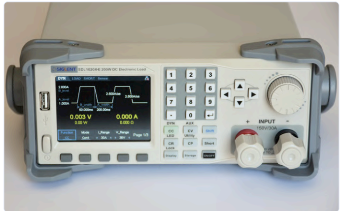
Le panneau frontal avec l'affichage montrant le réglage des formes d'onde dynamiques.
