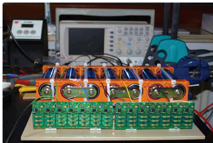
Figure 7. Batterie LiFePo avec équilibreur du clone Segway de l'auteur.
