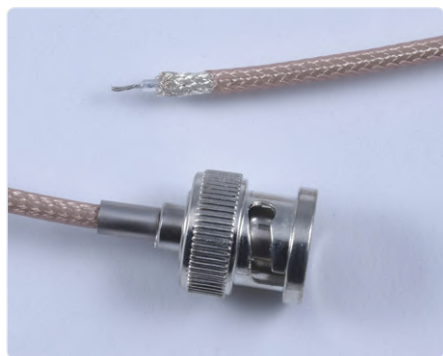
Figure 7. Câble coaxial RG316 avec extrémité dénudée et connecteur serti à l'autre extrémité.
