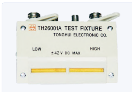
Figure 15b. TH26001A, module de test compact, plus coûteux.
