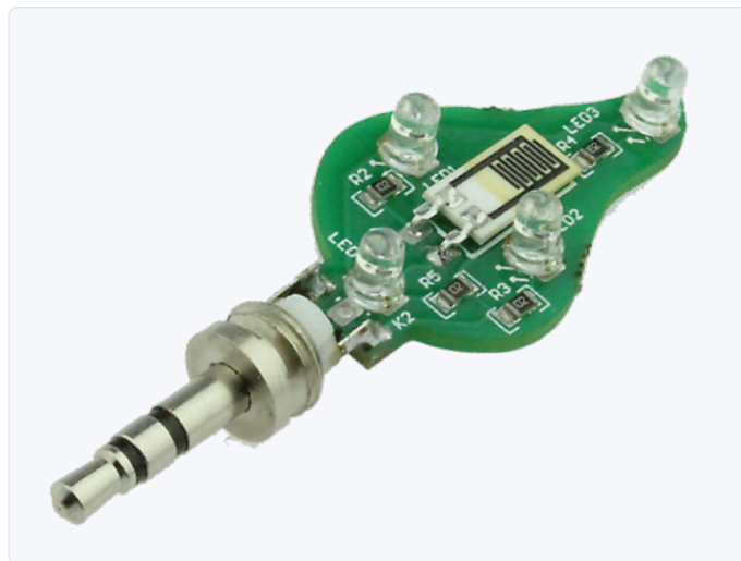
Figure 4a. Le circuit imprimé de la flamme, les LED et le capteur avec la prise jack connectée.
