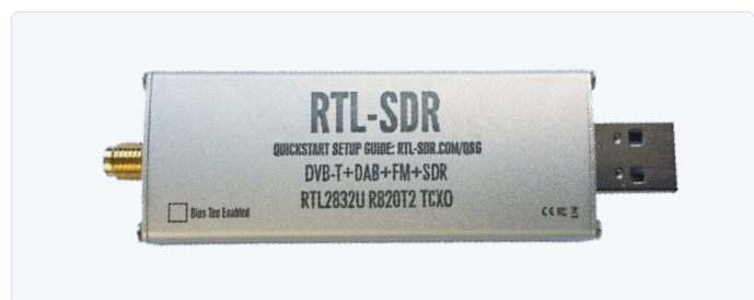
Figure 2. Le RTL-SDR décode de nombreux signaux sans-fil, y compris les stations météo qui émettent en 433,92 MHz.
