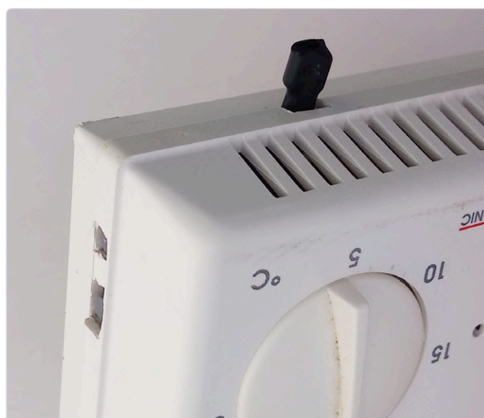
Figure 6. Assemblage terminé. Les deux boutons-poussoirs sont accessibles par deux découpes (à gauche) et le capteur de température dépasse en dessous. Les LED verte et jaune ne sont visibles qu'à travers les fentes d'aération pour éviter d'éclairer la pièce la nuit. Elles sont de couleur différente pour qu'on voie bien laquelle des deux est allumée.
