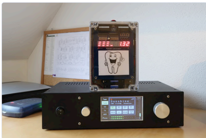
Figure 5. Minuterie de brossage de dents avec MyNOR v1.0 plus l'affichage à 7 segments v1.0. L'appareil sur lequel est posée la minuterie est un récepteur haut de gamme (FM et DAB+) avec égaliseur à 11 bandes intégré et commande tactile, construit par Dennis l'an dernier.
