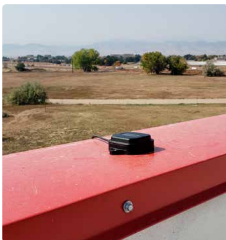
Figure 1. L'antenne U-blox fixée au parapet de SparkFun.
