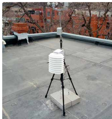
Figure 2. Station météorologique sur trépied lesté.
