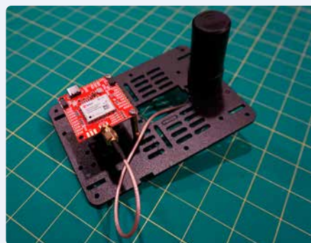
Figure 3. La carte GPS montée sur un châssis séparé, installée au-dessus de la Jetson Nano et de la monture de la caméra.
