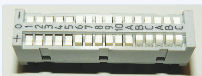
Figure 7. Un commutateur DIP à trois voies 0/1/haute impédance.
