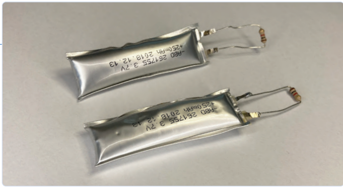
Figure 8. Batterie plate endommagée et gonflée.
