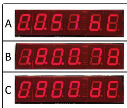
Figure 5. A : entrée de 81 dec dans le registre BC. B : adresse de départ. C : résultat 9 dec dans le registre DE.
