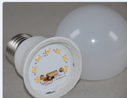
Figure 4. On peut récupérer des LED en bon état dans les lampes à LED hors service, car la panne vient en général du circuit de commande.
