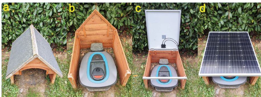
Figure 6. Les quatre étapes de la transformation d'une niche pour chien mal utilisée en un garage solaire pour mon robot de tonte.
