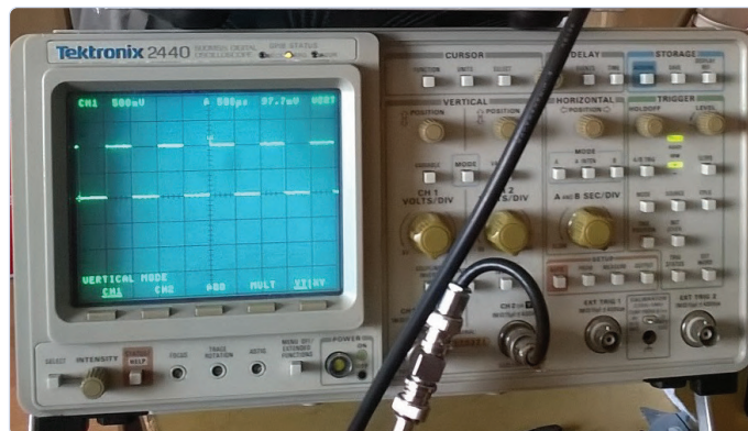
Figure 2. L'oscilloscope à échantillonnage numérique Tektronix 2440 à deux canaux, 300 MHz, 500 Méc/s, datant de la fin des années 1980. (Source : tekwiki [2])
