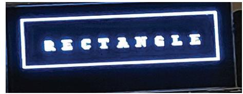
Figure 8. L'affichage obtenu en exécutant OLEDRect.py.
