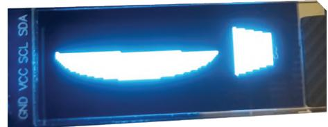
Figure 10. L'affichage obtenu en exécutant OLEDShape2.py (corde et polygone).
