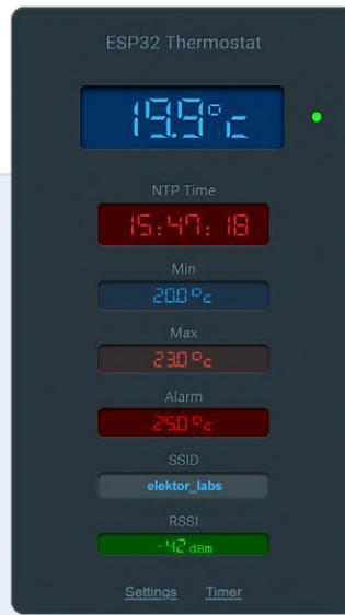
Figure 5. La page principale affiche la température mesurée ainsi que les seuils de commutation et d'alarme.
