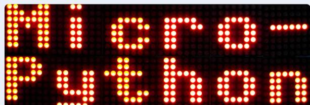
Figure 6. Affichage matriciel par points avec douze éléments de matrice
