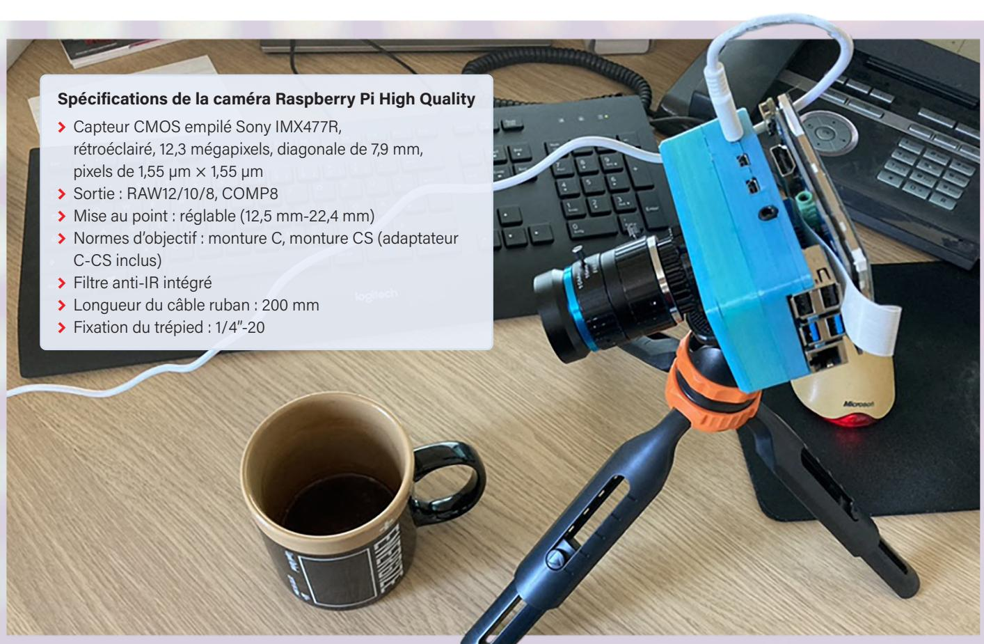
Figure 1. Configuration de la caméra Raspberry Pi HQ.
