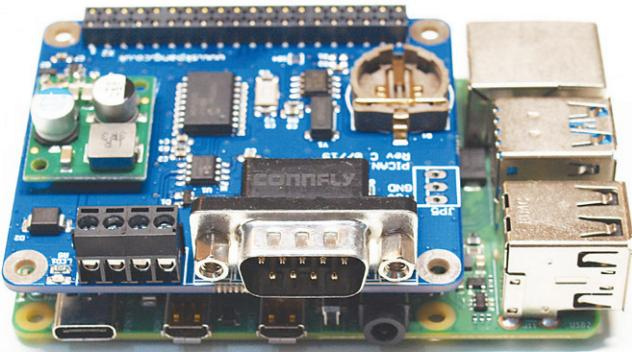
Figure 2. La carte PiCAN 3 permet de se connecter à un bus CAN de deux façons.
