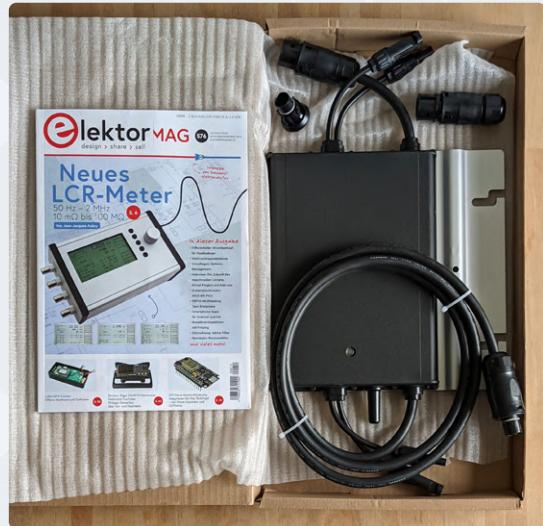
Figure 3. L'onduleur de réseau HM-600 (un exemplaire d'Elektor donne l'échelle).
