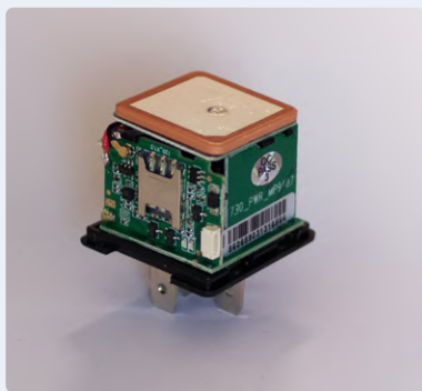
Figure 5. L'intérieur du traceur GSM-GPS bon marché.
