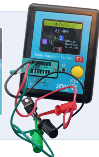
Figure 3. Test des composants dans le connecteur ZIF ou avec les clips de test.
