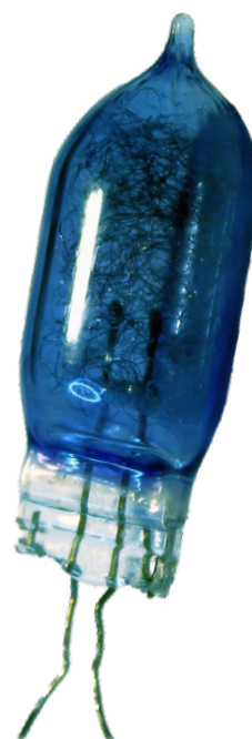
Figure 1. Cette ampoule de flash au magnésium est la pierre angulaire de notre alarme anti-effraction.
