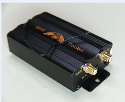
Figure 7. Prises d'antenne du traceur GSM-GPS TK103.
