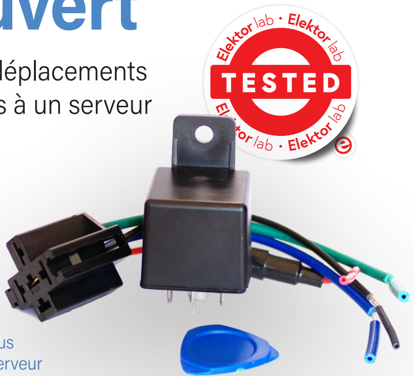
Figure 1. Un traceur GSM-GPS à petit budget.
