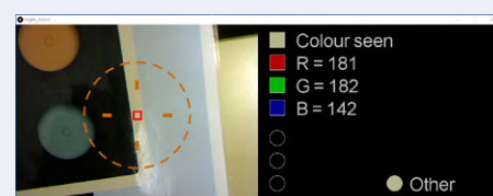
Figure 11. Classification erronée d'autres couleurs dans la catégorie « vert » résolue à l'aide du nœud de sortie « autre ».
