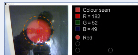
Figure 9. tlight_detect.pde après apprentissage des couleurs rouge, ambre et vert.
