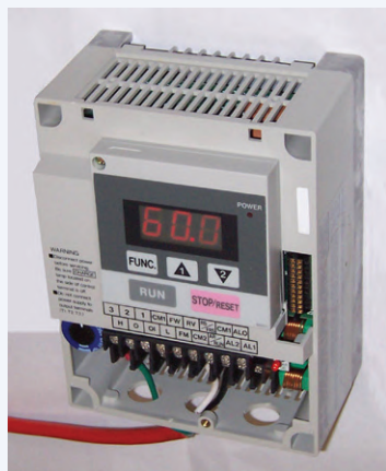
Figure 8. Petit variateur de fréquence pour moteurs à induction de quelques kW. Ce circuit de commutation électronique permet de régler le régime. Des modèles plus conséquents offrant des fonctions avancées sont disponibles. (Crédit photo : C. J. Cowie, CC 3.0 [6])
