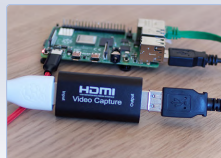
Figure 19. Installation terminée avec la clé d'acquisition HDMI-USB.
