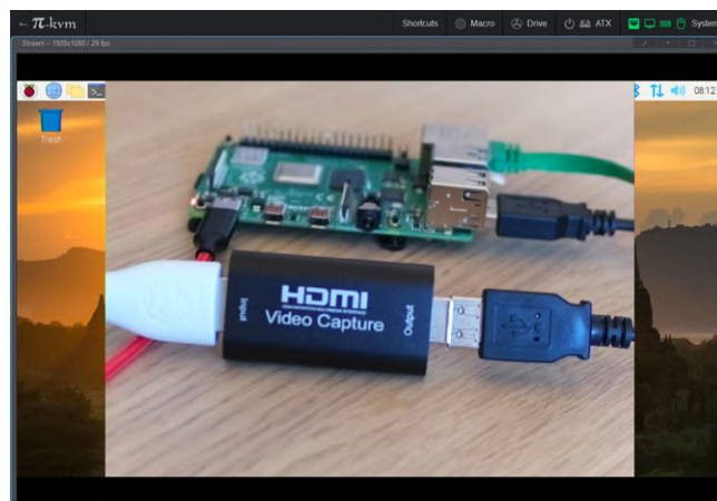
Figure 22. Bureau de la caméra Raspberry Pi capturé avec la clé d'acquisition HDMI-USB.
