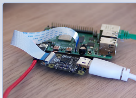
Figure 18. Installation terminée avec le pont HDMI-CSI.
