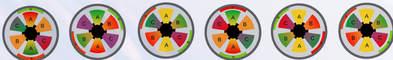
Figure 23. Le rotor est entraîné par deux des trois paires d'enroulements.
