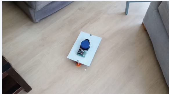
Figure 8. Le chariot évite les obstacles grâce à un simple algorithme de recherche d'un écart minimal.
