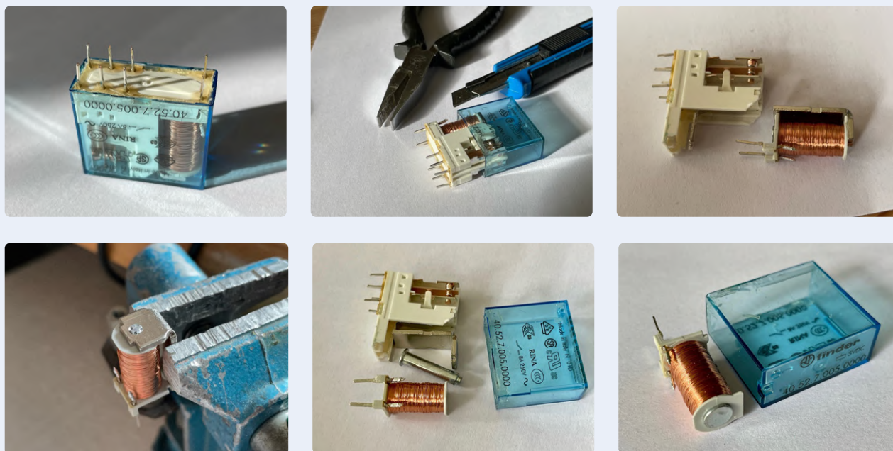
Figure 3. Démontage du relais et préparation du solénoïde.
