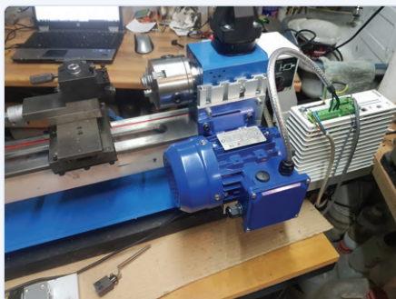
Figure 7. Montage du moteur de 0,37 kW et du variateur.
