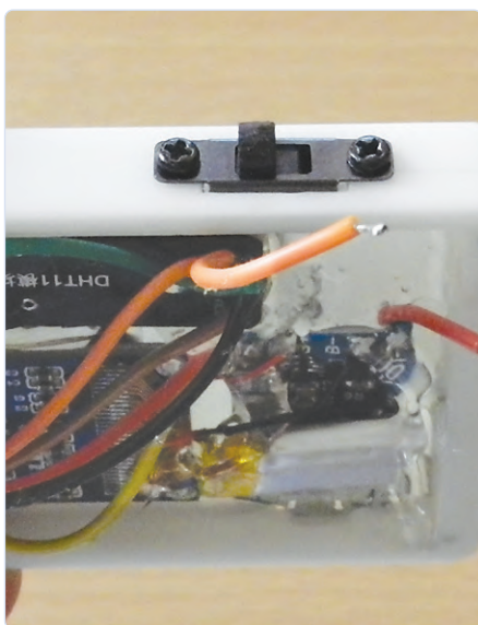
Figure 7. L'interrupteur est fixé à l'extérieur du boîtier.
